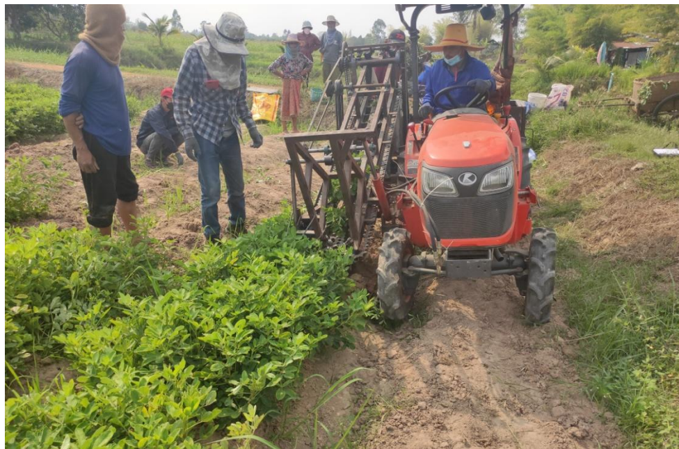
เครื่องขุดเก็บและปลิดฝักถั่วลิสงแบบติดพ่วงรถแทรกเตอร์
