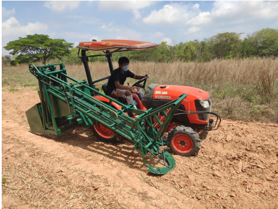
เครื่องขุดเก็บและปลิดฝักถั่วลิสงแบบติดพ่วงรถแทรกเตอร์
