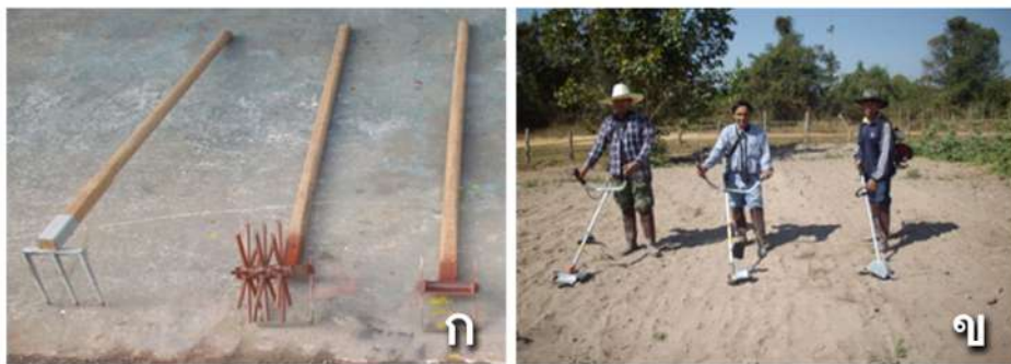
ภาพที่ 27 (ก) เครื่องมือพรวนดิน และ (ข) เครื่องมือพรวนดินแบบติดกับเครื่องตัดหญ้าแบบสะพาย
