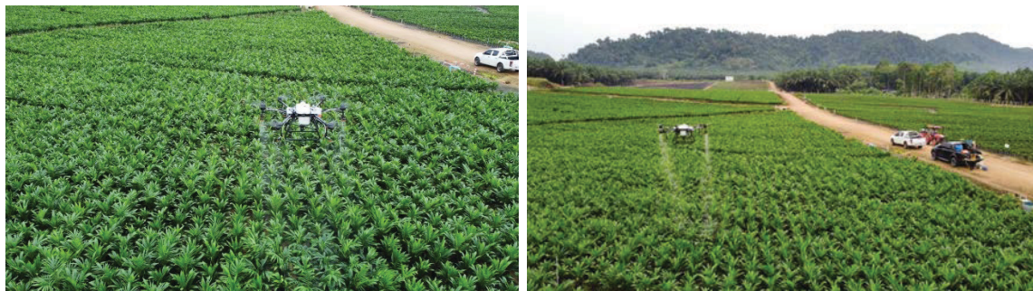
ภาพที่ 38 โดรนฉีดพ่นปุ๋ยน้ำทางใบ สารป้องกันและกำจัดโรคและแมลงในระยะต้นกล้า แปลงเพาะกล้าปาล์มน้ำมันบริษัทยูนิวานิชน้ำมันปาล์ม จำกัด (มหาชน)
