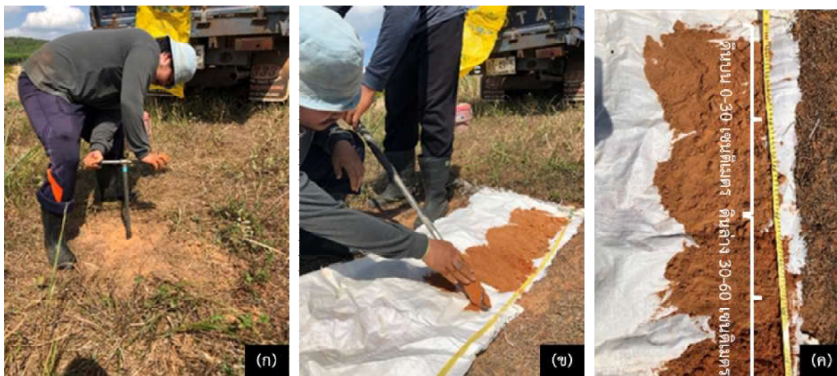
ภาพที่ 39 วิธีการเก็บตัวอย่างดินสำหรับวิเคราะห์ปริมาณธาตุอาหาร (ก) การเจาะดินเพื่อเก็บตัวอย่างดินด้วยเครื่องสว่านมือ (Hand Auger) (ข) การเก็บตัวอย่างดินที่ 2 ระดับความลึก (ค) ตัวอย่างดิน 2 ระดับ ดินบน 0-30 เซนติเมตร และดินล่าง 30-60 เซนติเมตร
