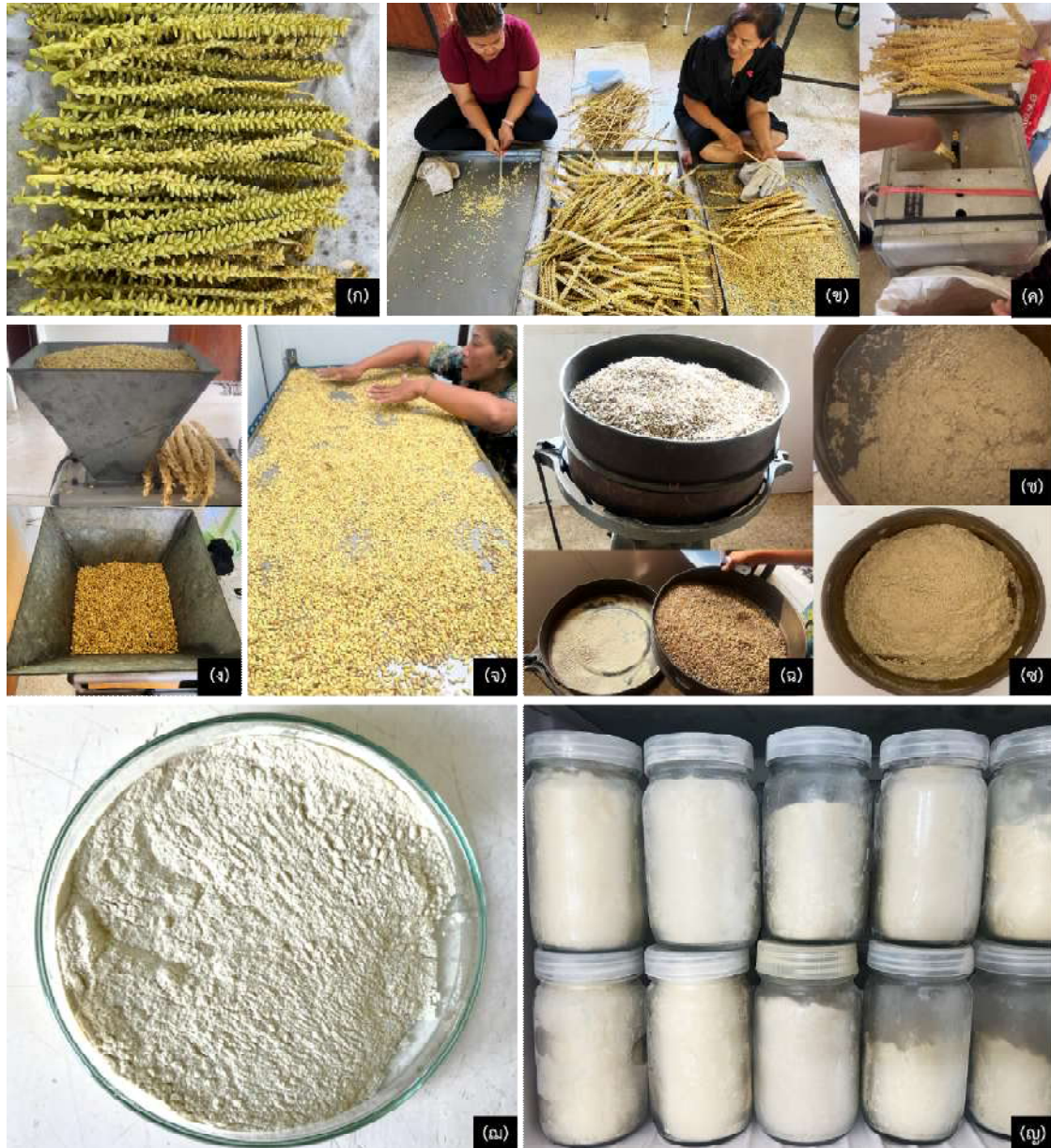
ภาพที่ 25 ขั้นตอนการผลิตละอองเกสรมะพร้าวน้ำหอม (ก) ลักษณะดอกตัวผู้แก่จัด (ข) ปลิดดอกตัวผู้ด้วยการใช้มือ (ค) การปลิดดอกตัวผู้ด้วยการใช้เครื่องปลิด (ง) บดดอกตัวผู้ด้วยเครื่องบด (จ) ตากดอกตัวผู้ (ฉ) ร่อนดอกตัวผู้ด้วยเครื่องกระแทกเพื่อให้ละอองเกสรหลุดออกมา (ช) ร่อนละอองเกสรด้วยตะแกรงหยาบ (ซ) ร่อนละอองเกสรด้วยตะแกรงละเอียด (ฌ) ละอองเกสร (ญ) บรรจุละอองเกสรใส่ขวดแก้ว
