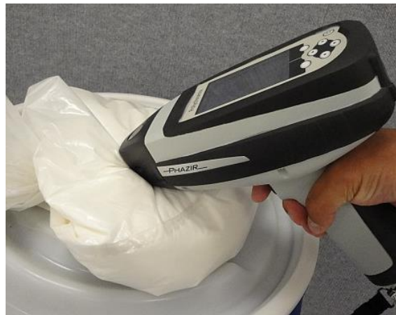
ภาพที่ 2.21 MicroPHAZIR™ (Thermoscientific, United States) แบบพกพา ช่วงความยาวคลื่น 1,600 – 2,400 นาโนเมตร (สืบค้นจาก http://tools.thermofisher.com/content/sfs/manuals/microPHAZIR-User-Manual.pdf )
