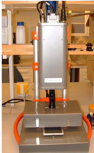
ภาพที่ 2.23 SisuCHEMA ใช้ในอุตสาหกรรมยา ช่วงความยาวคลื่น 970 – 2500 นาโนเมตร (สืบค้นจาก https://www.channelsystems.ca/sites/default/files/documents/pharma_ver0509.pdf )
