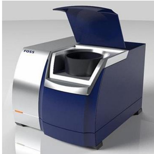
ภาพที่ 2.18 FOSS DS2500 (FOSS, Denmark) Flour Analyser ช่วงความยาวคลื่น 400 -2,500 นาโนเมตร (สืบค้นจาก https://www.fossanalytics.com/en/products/nirs-ds2500-flour-analyser )
