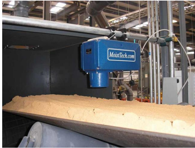
ภาพที่ 2.22 IR3000 (Moist Tech, North and South Africa) (สืบค้นจาก https://www.summit.dk/wp-content/uploads/2019/09/MoistTech-IR-3000-Online-Brochure-1.pdf )
