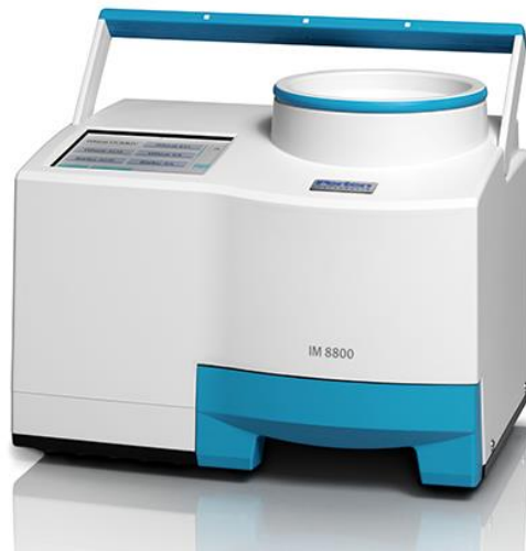
ภาพที่ 2.20 Inframatic 8800 (Perten Instruments, Sweden) NIR Grain Analyzer ช่วงความยาวคลื่น 850-1,050 นาโนเมตร (สืบค้นจาก https://www.perten.com/Products/Inframatic-8800/Specifications )
