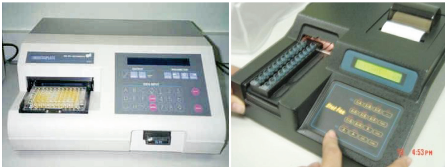
ภาพที่ 6.13 เครื่อง micro ELISA reader สำหรับอ่านค่าความเข้มของสี และคำนวณเป็นปริมาณสารพิษ โดยใช้โปรแกรม Log-Logit/Log
