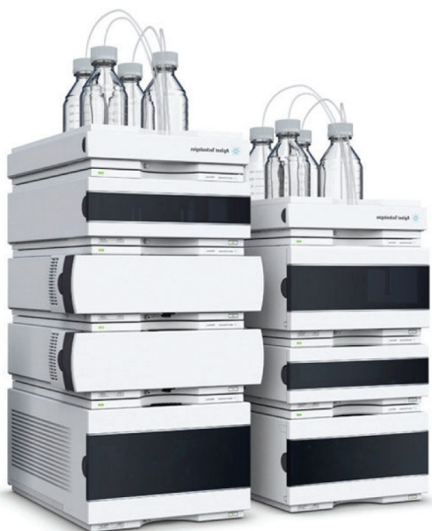
ภาพที่ 6.7 เครื่อง High Performance Liquid Chromatography (HPLC) ที่มา: www.agilent.com
