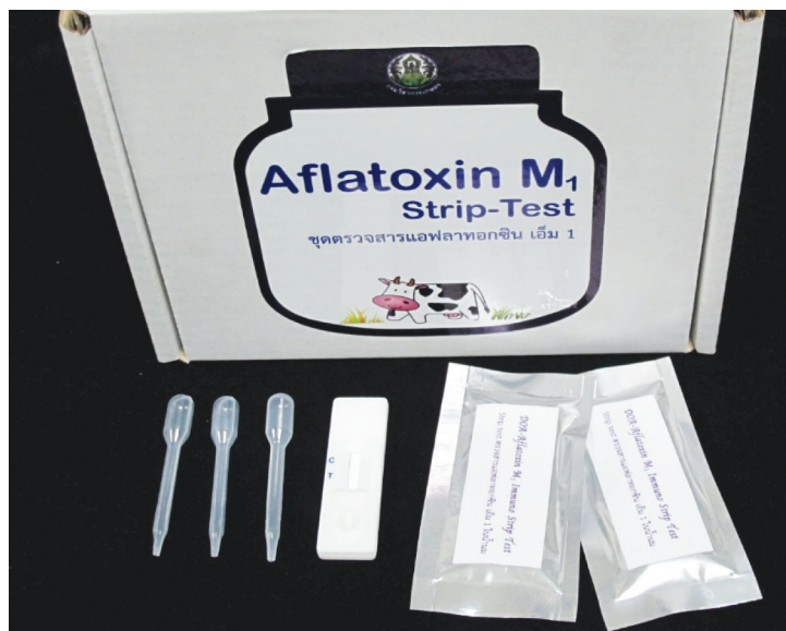
ภาพที่ 6.17 ชุดทดสอบสารแอฟลาทอกซิน เอ็ม1 ในน้ำมัน พัฒนาโดยกองวิจัยและพัฒนาวิทยาการหลังการเก็บเกี่ยว กรมวิชาการเกษตร
