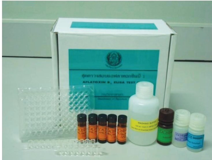
ภาพที่ 6.14 ชุดตรวจสอบสารแอฟลาทอกซินสำเร็จรูป (DOA-Aflatoxin ELISA test kit) ที่ผลิตโดยกรมวิชาการเกษตร
