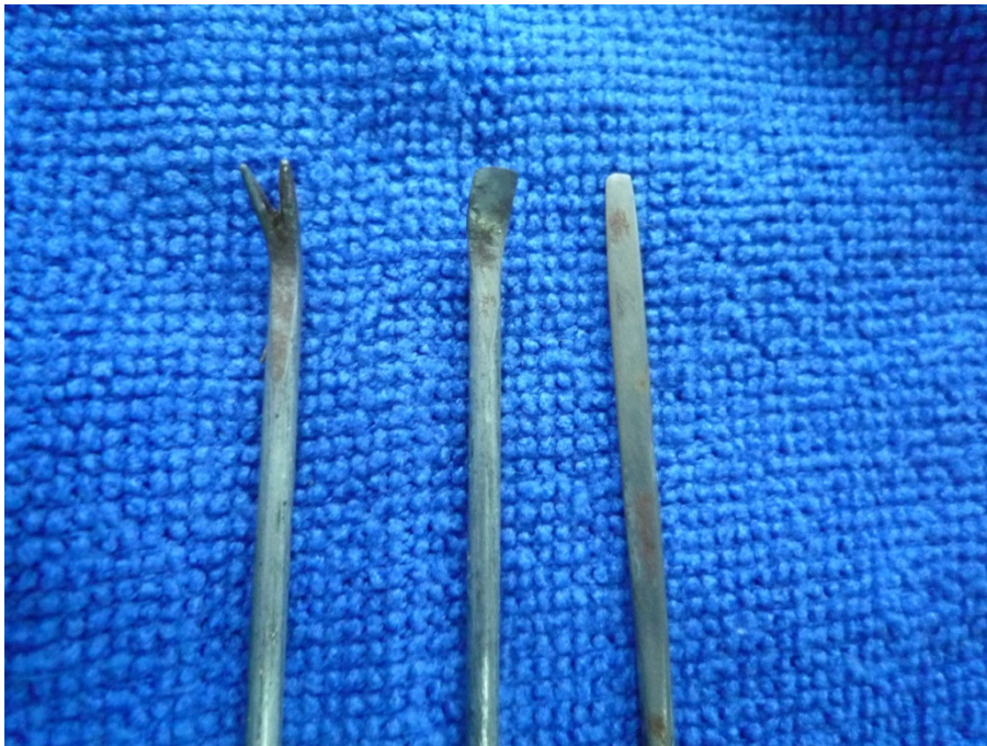
ลวดที่ปลายแบนเป็นรูปตัววี (V) และปลายแบนมน
