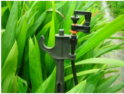
ภาพที่ 4.5 การให้น้ำแบบมินิสปริงเกลอร์ในโรงเรือนอนุบาลแรก
