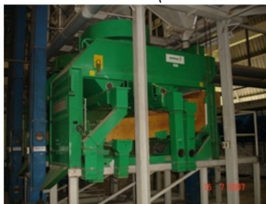
เครื่องทำความสะอาดเบื้องต้นและถังอบเมล็ดพันธุ์
