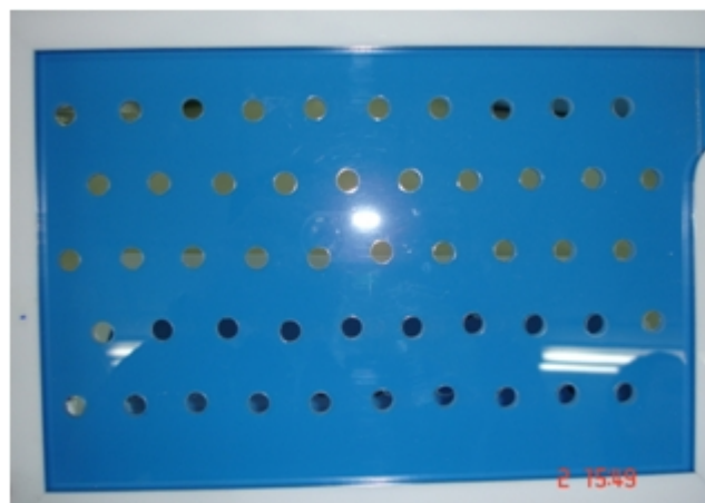
ภาพที่ 9 แผ่นนับเมล็ดสำหรับเพาะความงอก
