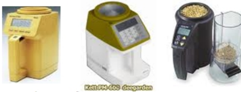
เครื่องวัดความชื้นด้วยกระแสไฟฟ้า สำหรับใช้ในภาคสนาม
