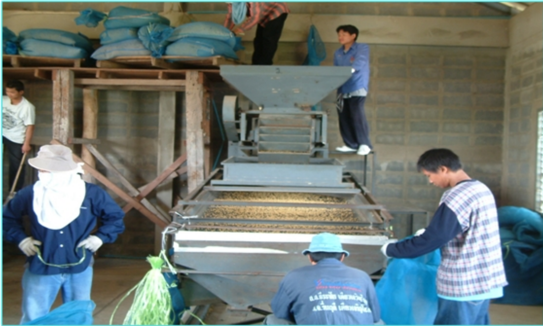
ภาพที่ 3 เครื่องคัดเมล็ดพันธุ์แบบใช้ตะแกรงและแรงลมขนาดกลาง
