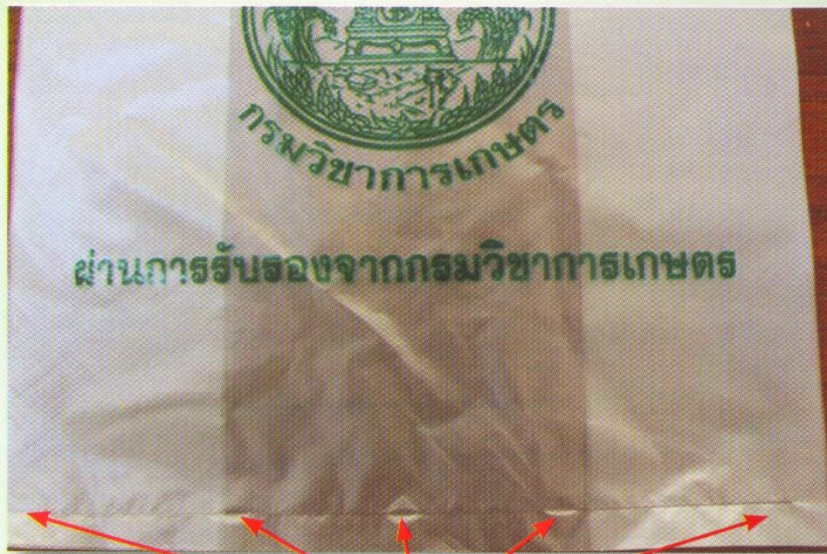
ลักษณะรูเจาะแบบซ้อนรูปที่เจาะสำเร็จมาจากโรงงาน
