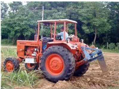
ขาไถระเบิดดินดาน (Subsoiler) หรือ ริปเปอร์ (Ripper)
