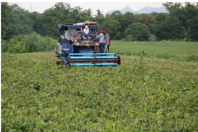
▲ การใช้เครื่องเกี่ยวขนาดสำหรับถั่วเขียว
