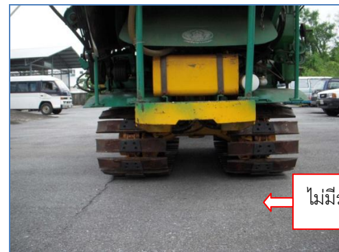
ภาพที่ 9 เปรียบเทียบผิวถนนก่อน และหลังติดตั้งยางดินตะขาบ
