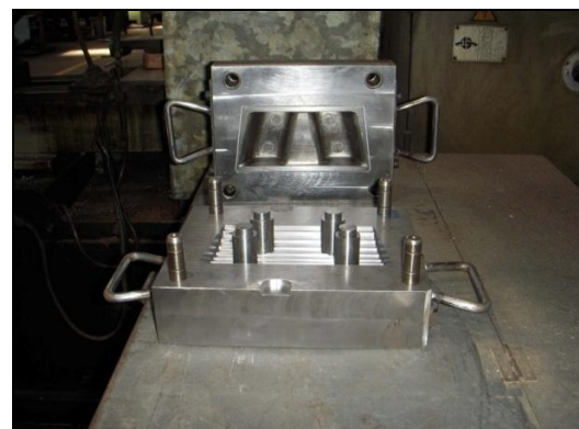
ภาพที่ 11 แบบยางดินตะขาบมีส่วน โค้งด้านหน้า และแม่พิมพ์
