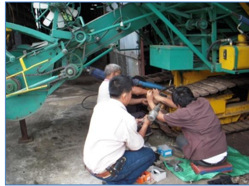
ภาพที่ 8 ยางดินตะขาบ และการติดตั้งกับดินตะขาบ
