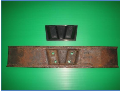
ภาพที่ 8 ยางดินตะขาบ และการติดตั้งกับดินตะขาบ
