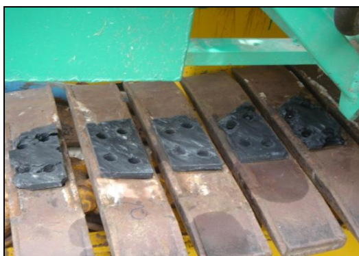
ภาพที่ 3 การฉีกขาดบริเวณผิวหน้ายางดินตะขาม
