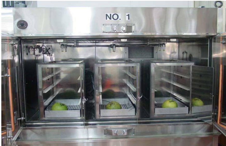
ภาพที่ 5 การเตรียมตู้อบไอน้ำเพื่อใช้ในการศึกษาประสิทธิภาพเบื้องต้นของวิธีการอบไอน้ำ
