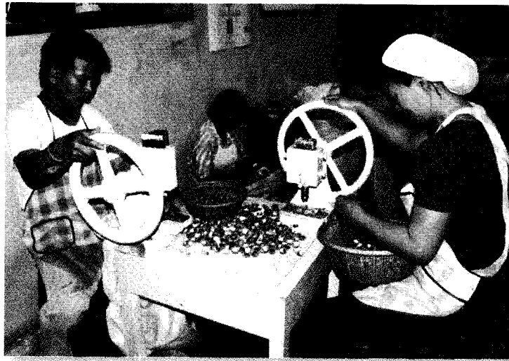
ภาพที่ 8 ทดสอบเปรียบเทียบการกะเทาะเมล็ดมะคาเดเมียที่สวนภูเรือวโนทยาน(ชาโตเดอเลย์) อำเภอภูเรือ จังหวัดเลย
