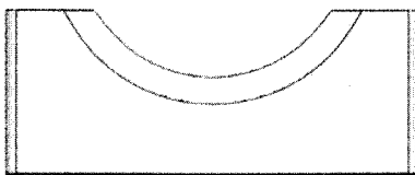
ภาพที่ 6 ลักษณะของใบมีดกะเทาะบนและล่างปรับปรุงใหม่
