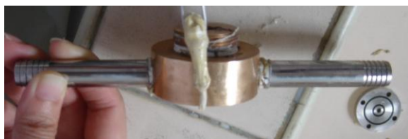
เจลยางที่จับตัวภายในแม่แบบส่วนเย็น (ขนาดใหญ่) เจลยางที่จับตัวภายในแม่แบบส่วนร้อน (ขนาดเล็กและใหญ่)
