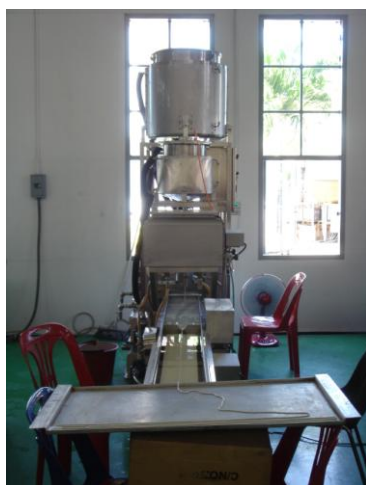
รูปที่ 5 การผลิตเส้นด้ายยางขนาดเส้นผ่าศูนย์กลาง 3 มิลลิเมตร ด้วยเครื่องต้นแบบ ที่อุณหภูมิเย็นและร้อนของแม่แบบ ที่ 20 และ 50 องศาเซลเซียส ตามลำดับ
