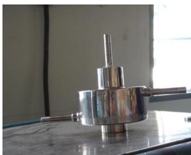
รูปที่ 3 แม่แบบเส้นด้ายขนาดเส้นผ่าศูนย์กลาง 3 มิลลิเมตร ที่เป็นชิ้นเดียวกันทำจากสแตนเลส
