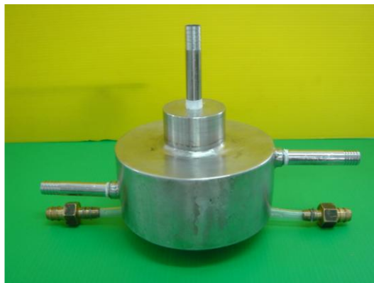
รูปที่ 10 แม่แบบเส้นด้ายยางขนาดเส้นผ่าศูนย์กลาง 1 มิลลิเมตร ที่ปรับในส่วนเย็นให้เริ่มมีเส้นผ่าศูนย์กลาง 1 มิลลิเมตร
