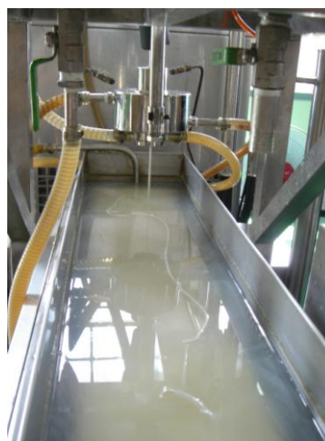
รูปที่ 5 การผลิตเส้นด้ายยางขนาดเส้นผ่าศูนย์กลาง 3 มิลลิเมตร ด้วยเครื่องต้นแบบ ที่อุณหภูมิเย็นและร้อนของแม่แบบ ที่ 20 และ 50 องศาเซลเซียส ตามลำดับ
