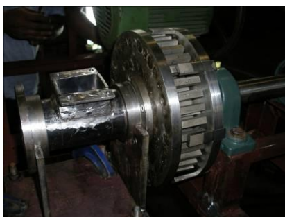
ภาพที่ 3.11 แสดงลักษณะการประกอบทำงานของจานบด ภาพที่ 3.12 ตะแกรงละเอียดครอบจานบด
