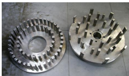
ภาพที่ 3.10 งานบดที่สร้างขึ้นตามแบบ
