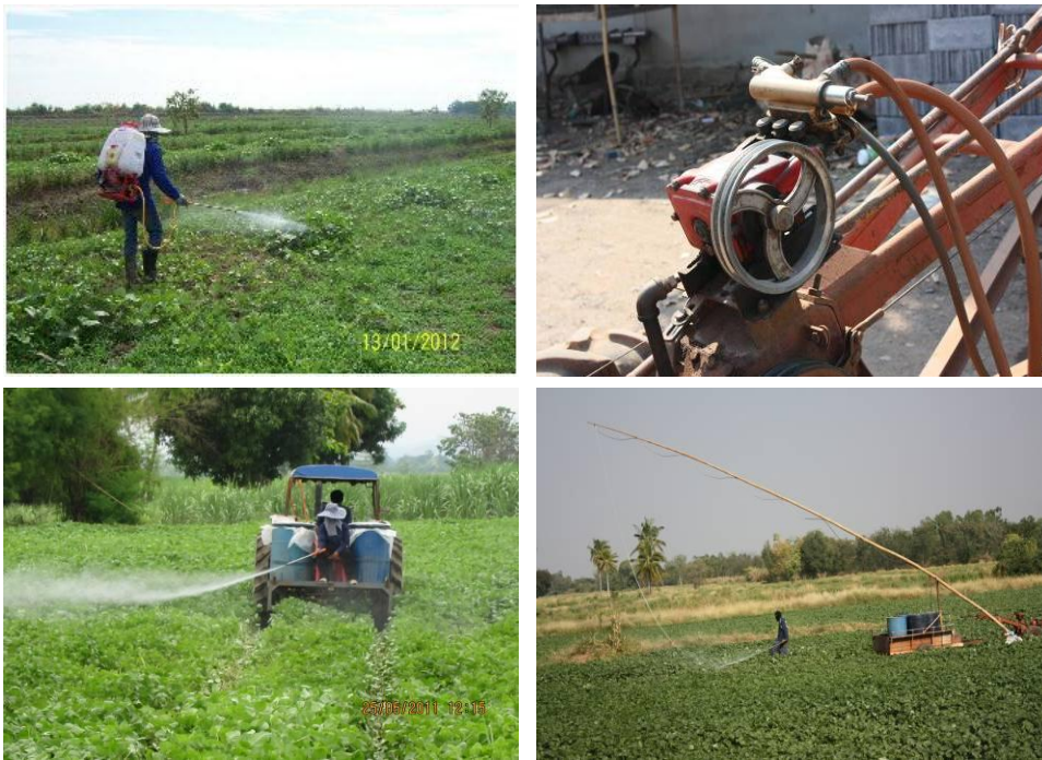
ภาพที่ 1.2 อุปกรณ์พ่นสารเคมีแบบสะพายหลังและแบบปั๊มแรงดันสูงต่อสายยาว
