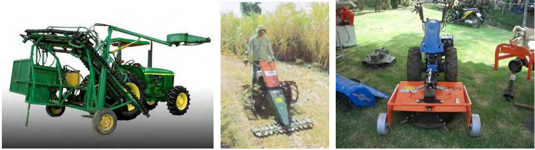
ภาพที่ 1.17 ตัวอย่างรถตัดอ้อยแบบเป็นลำที่มีจำหน่ายในท้องตลาด
