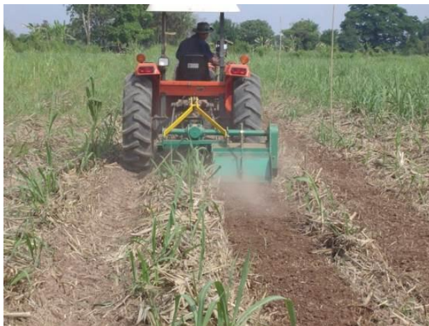
ภาพที่ 1.8 ทดสอบสับกลบใบอ้อยที่มีความหนาระหว่าง 10-15 เซนติเมตร
