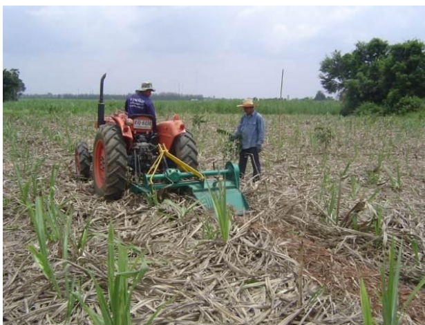
ภาพที่ 1.13 การทดสอบต้นแบบติดพ่วงกับรถแทรกเตอร์ 34 แรงม้า
