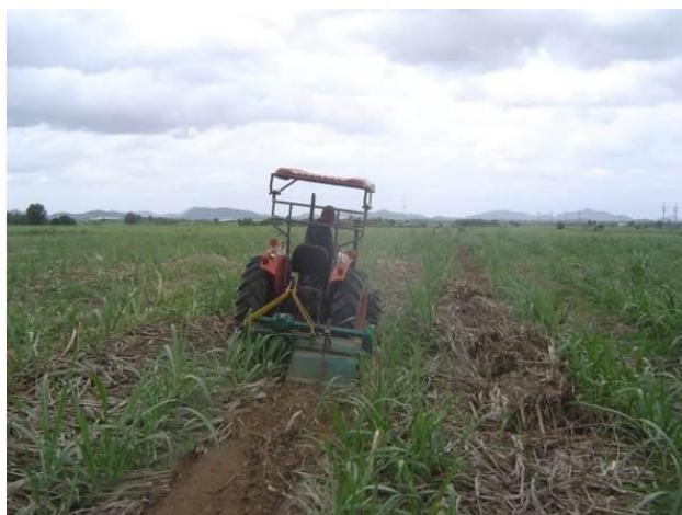
ภาพที่ 1.15 ทดสอบจอบหมุนสับกลบใบอ้อยตัดฟุ้งรดแทรกเตอร์ขนาด 34 แรงม้า
