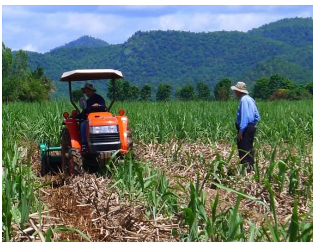
ภาพที่ 1.16 จอบหมุนที่ติดตั้งกับรถแทรกเตอร์ 34 แรงม้า ต้องวิ่งคร่อมร่อง
