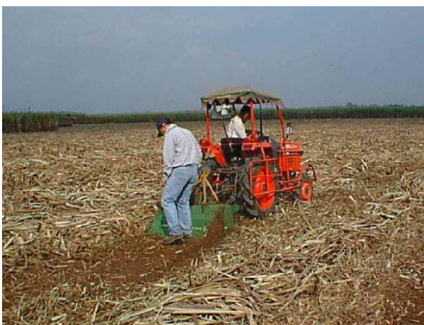
ภาพที่ 1.2 จอบหมุนต้นแบบที่ออกแบบในปี 2545
