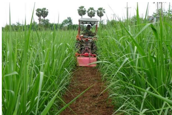
ภาพที่ 1.20 ทดสอบจอบหมุนกำจัดวัชพืชดัดพ่วงรถแทรกเตอร์ขนาด 24 แรงม้า
