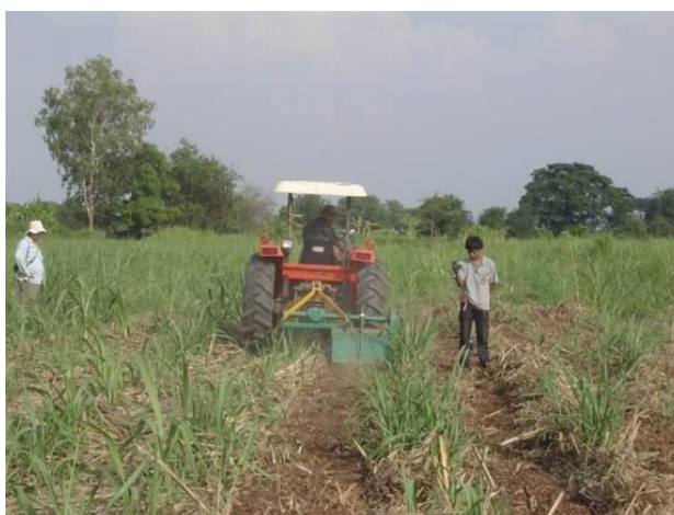
ภาพที่ 1.12 ทดสอบจอบหมุนสับกลบใบอ้อยติดพ่วงรถแทรกเตอร์ 50 แรงม้า
