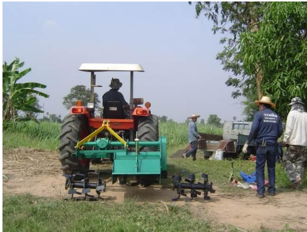
ภาพที่ 1.7 การทดสอบใบจอบหมุนทั้งสามชนิดในแปลงทดสอบ
