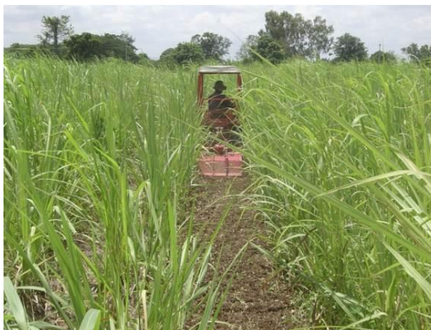
ภาพที่ 1.19 ทดสอบจอบหมุนสับกลบใบอ้อยติดฟางรถแทรกเตอร์ขนาด 24 แรงม้า
