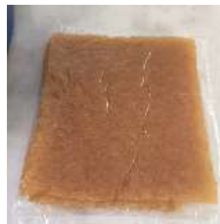
6. นำยางที่บดเป็นเนื้อเดียวกันมาขึ้นแผ่น ก่อนมาตัดแบ่ง
