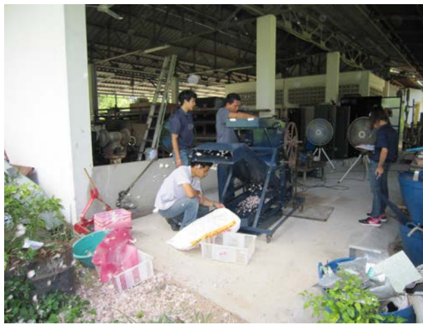
ภาพที่ 1.7-1 แสดงการทดสอบต้นแบบเครื่องแกะกระเทียม
