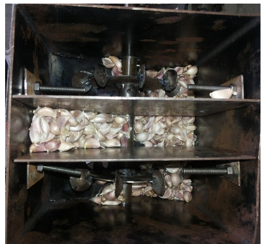
ภาพที่ 2.4-5 การปรับปรุงเครื่องปลูกกระเทียมแบบกระพ้อตัก ให้มีส่วนห้องเก็บกระเทียม ห้องป้อน และห้องตักกระเทียม เพื่อความแม่นยำยิ่งขึ้น
