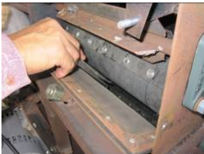
ภาพที่ 1.5-1 แก้ไขปรับปรุงลูกยางกะเทาะตัวบนและแผ่นตั้งระยะปาก
