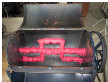
ภาพที่ 1.6-2 แสดงแกนใบกวนที่หุ้มด้วยวัสดุพลาสติกเส้นสานเหนียวกันกระทบ
