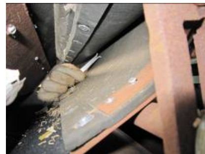
ภาพที่ 1.5-2 แก้ไขปรับปรุงลูกยางกะเทาะตัวล่างและแผ่นตั้งระยะปาก
