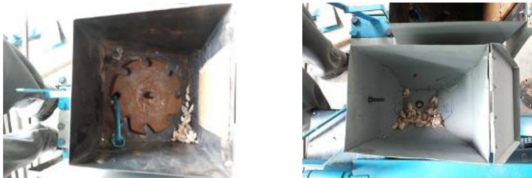
ภาพที่ 2.2-1 ลักษณะกลไกการหยอดของต้นแบบ แบบจานหยอดและแบบลูกหยอด เพื่อหยอดกลีบกระเทียมขนาดที่ต่างกันและการทำงานที่ต่างกัน
