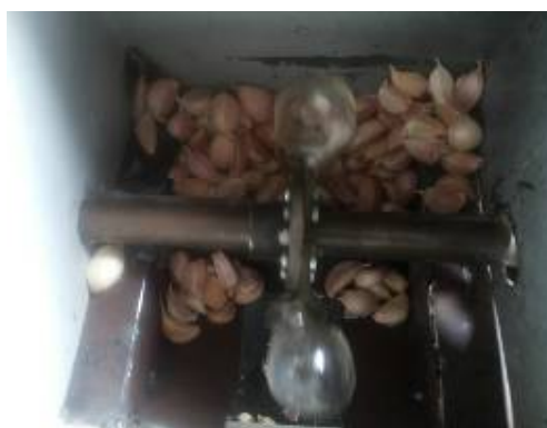
ภาพที่ 2.2-2 ลักษณะกลไกการหยอดของต้นแบบ แบบกระพ้อตัก เพื่อหยอดกลีบกระเทียมที่ได้คัดขนาดใกล้เคียงกันแล้ว
