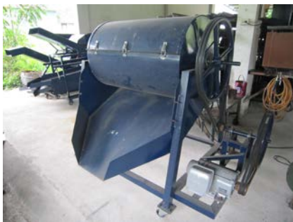
ภาพที่ 1.6-1 แสดงเครื่องขัดเปลือกและทำความสะอาดกลีบกระเทียม
