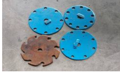
ภาพที่ 2.3-1 การเลือกงานหยอดและปลอกลูกหยอดที่มีขนาดเหมาะสมกับขนาดกลีบกระเทียม แต่ละพันธุ์ที่แตกต่างกัน
