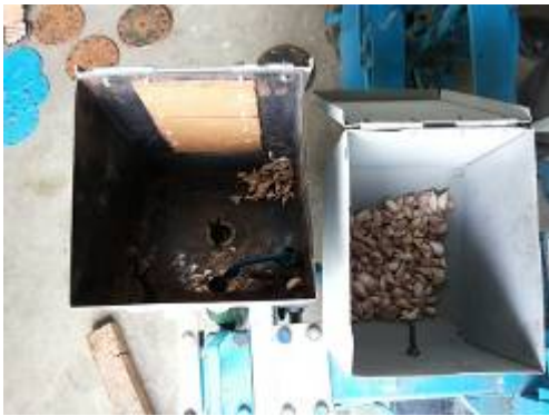
ภาพที่ 2.3-2 การทดสอบขนาดกลีบกระเทียมกับงานหยอดและปลอกลูกหยอดที่มีขนาดเหมาะสม
