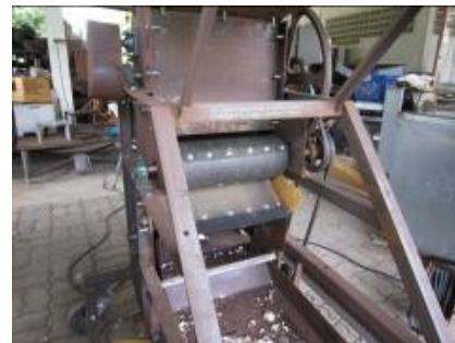
ภาพที่ 1.4-4 แสดงลูกยางกะเทาะตัวล่างและแผ่นตั้งระยะปาก
