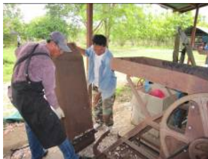
ภาพที่ 1.5-4 แก๊ไขปรับปรุงปล่องลมออก ของชุดพัดลมทำความสะอาด
