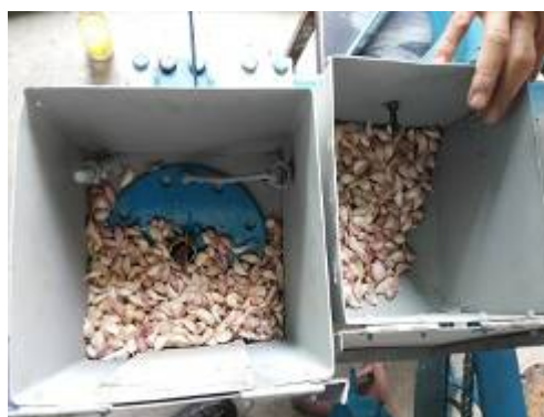
ภาพที่ 2.4-2 การทดสอบเปรียบเทียบการทำงานของกลไกการหยุด 2 แบบ คือแบบจานหยุดและแบบลูกหยุด
