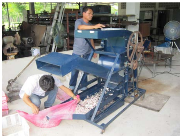
ภาพที่ 1.5-5 ลักษณะเครื่องแกะกระเทียมแบบลูกยางกะเทาะ 2 ลูก ที่ปรับปรุงแล้ว
