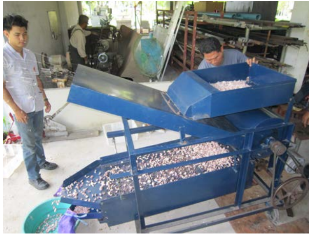
ภาพที่ 1.5-6 ลักษณะเครื่องคัดขนาดกลีบกระเทียมแบบตะแกรงโยกคัดขนาดที่ปรับปรุงแล้ว
