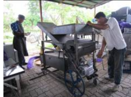
ภาพที่ 1.4-2 ต้นแบบเครื่องคัดขนาดกลีบกระเทียมแบบตะแกรงโยกคัดขนาด
