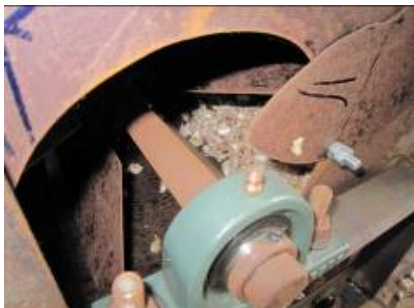
ภาพที่ 1.5-3 แก๊ไขปรับปรุงแผ่นปิดบังคับ ลมเข้าของชุดพัดลมทำความสะอาด
