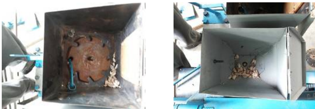
ภาพที่ 2.4-1 เปรียบเทียบลักษณะของกลไกการหยุด 2 แบบ คือแบบจานหยุดและแบบลูกหยุด
