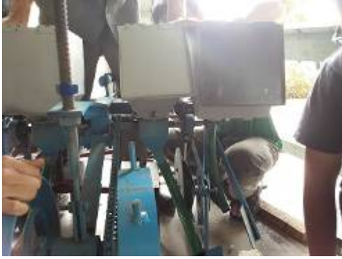
ภาพที่ 2.4-3 การทดสอบเปรียบเทียบการใช้งานของเครื่องต้นแบบ ด้วยกลไกการหยอด 2 แบบ คือ แบบจานหยอดและแบบลูกหยอด
