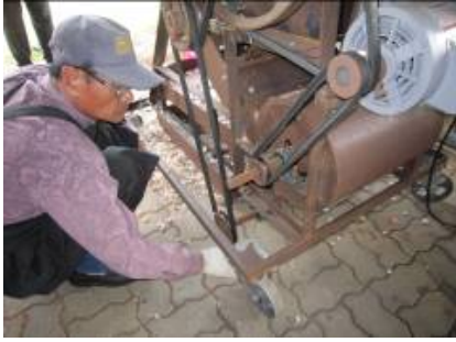
ภาพที่ 1.4-5 แสดงพัฒน์ทำความสะอาดแบบใบพัดตรง 5 ใบ
