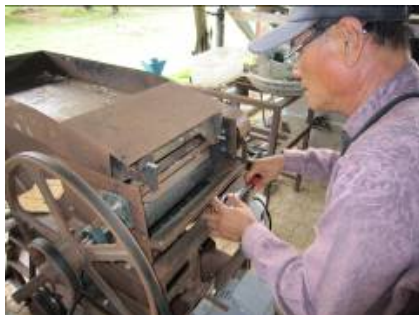
ภาพที่ 1.4-3 แสดงลูกยางกะเทาะด้านบนและแผ่นตั้งระยะปาก
