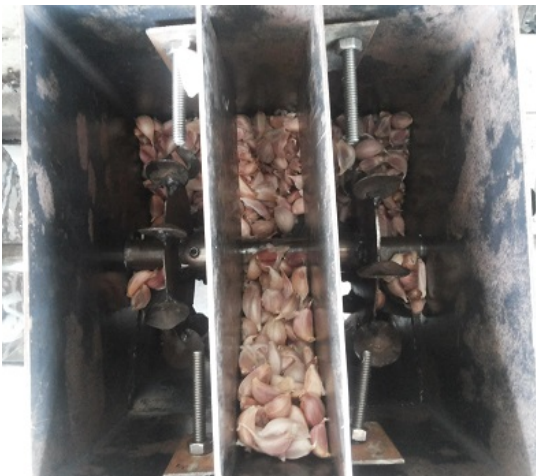
ภาพที่ 2.4-5 การปรับปรุงเครื่องปลูกกระเทียมแบบกระพ้อตัก ให้มีส่วนห้องเก็บกระเทียม ห้องป้อน และห้องตักกระเทียม เพื่อความแม่นยำยิ่งขึ้น
