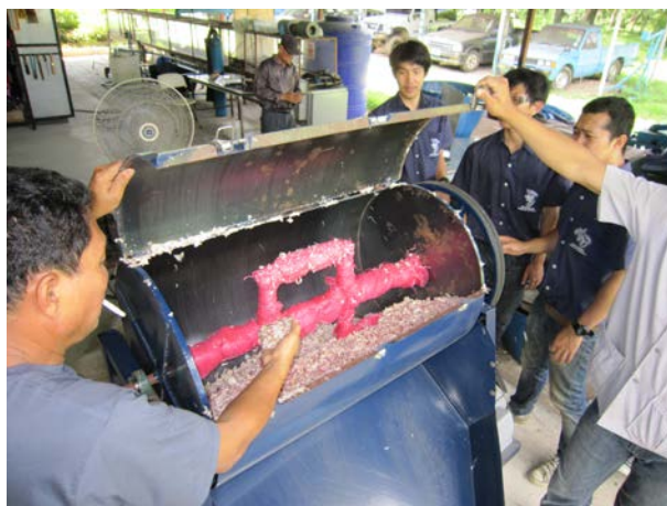
ภาพที่ 1.7-2 แสดงการทดสอบต้นแบบเครื่องขัดเปลือกกระเทียม
