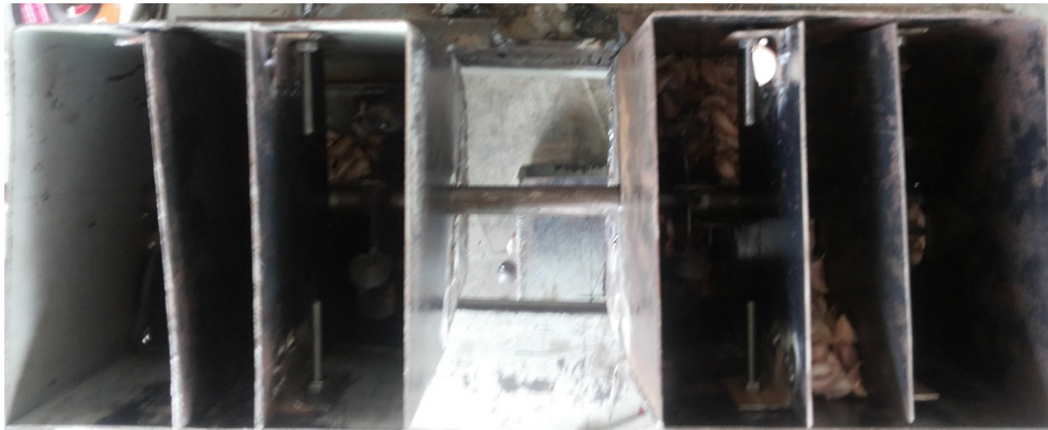
ภาพที่ 2.4-4 การทดสอบเปรียบเทียบการทำงานของกลไกการหยอดแบบกระพ้อตัก แถวคู่
