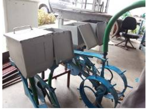
ภาพที่ 2.4-3 การทดสอบเปรียบเทียบการใช้งานของเครื่องต้นแบบ ด้วยกลไกการหยอด 2 แบบ คือ แบบจานหยอดและแบบลูกหยอด
