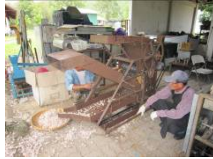
ภาพที่ 1.4-6 แสดงตะแกรงโยกทำความสะอาดใช้เพลลาเยื้องศูนย์
