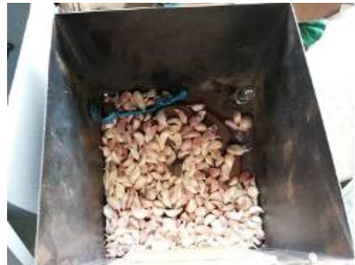
ภาพที่ 2.3-2 การทดสอบขนาดกลีบกระเทียมกับงานหยอดและปลอกลูกหยอดที่มีขนาดเหมาะสม
