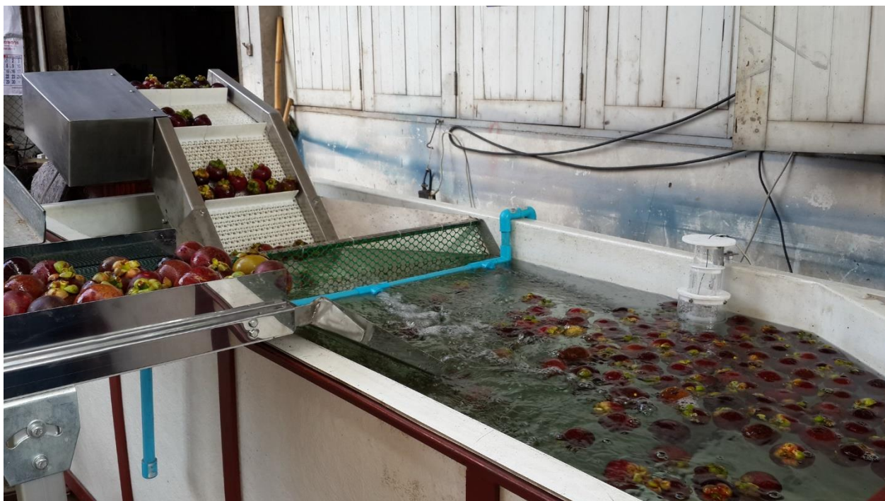
ภาพที่ 28 การทดสอบประสิทธิภาพระบบลำเลียงมังคุดส่วนจมออกจากถังคัดแยก
