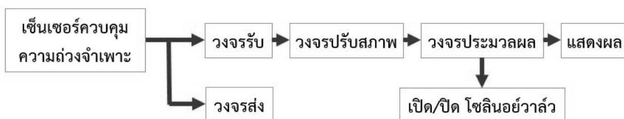
ภาพที่ 1 ผังงานวงจรรวมของต้นแบบระบบควบคุมความถ่วงจำเพาะแบบเสียงอัลตราโซนิก
