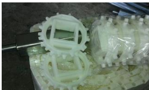
ภาพที่ 15 ล้อฟันเฟืองโพลีโพรพิลีน และ สายพานลำเลียงโพลีโพรพิลีน
