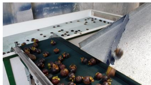
ภาพที่ 11 ระบบลำเลียงมังคุดเข้าถังคัดแยกแบบใหม่
