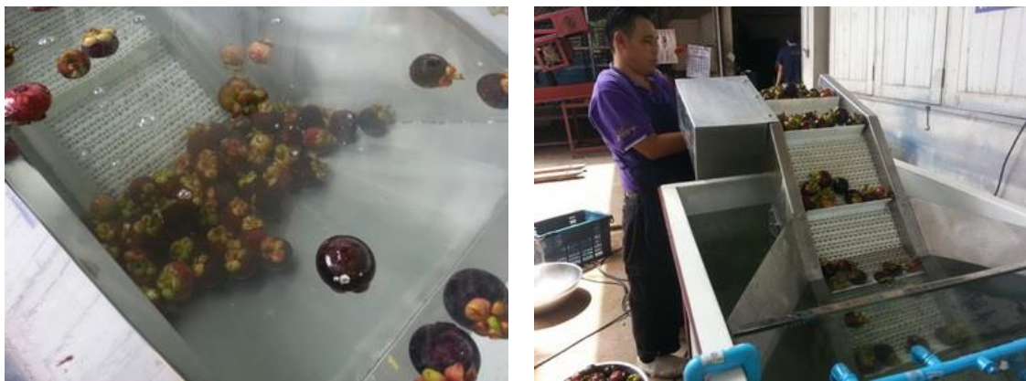
ภาพที่ 16 ระบบลำเลียงมังคุดส่วนจมออกจากถังคัดแยกเบื้องต้น
