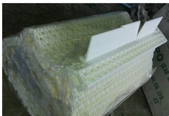
ภาพที่ 15 ล้อฟันเฟืองโพลีโพรพิลีน และ สายพานลำเลียงโพลีโพรพิลีน
