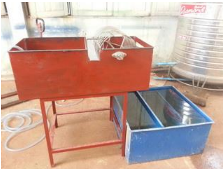
ภาพที่ 20 การทดสอบระบบลำเลียงผลมังคุดส่วนลอยน้ำในถังคัดแยกเบื้องต้น
