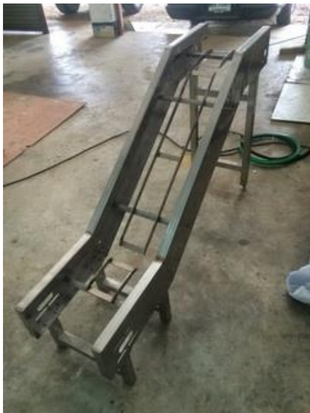
ภาพที่ 14 โครงสร้างของระบบลำเลียงมุ้งคูดส่วนจมออกจากถังคัดแยก
