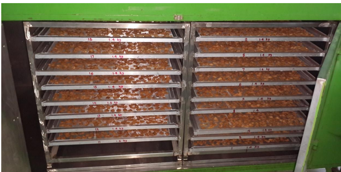
ภาพที่ 12 ใช้เวลาอบประมาณ 9 ชม. ได้น้ำหนักเนื้อแห้งรวมเฉลี่ย 20.27 กิโลกรัม
