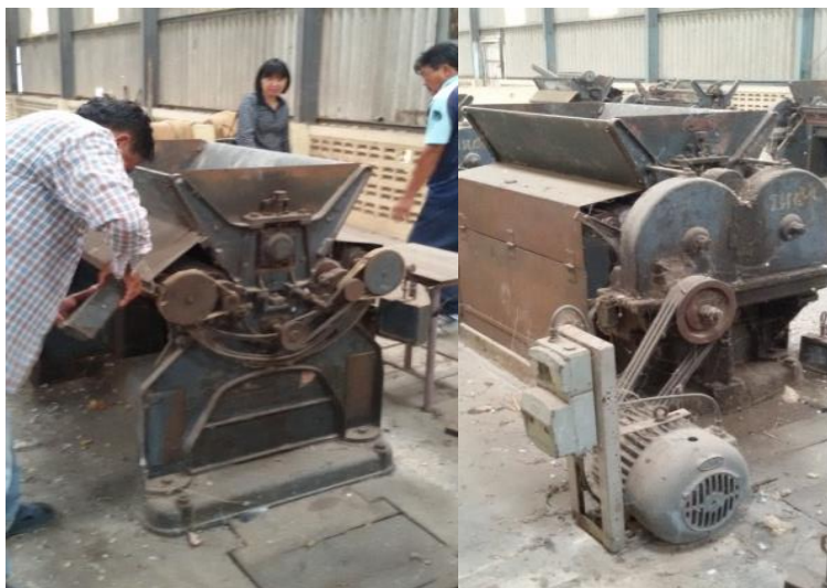
ภาพที่ 1.10 เครื่องทอฝ้ายแบบลูกกลิ้งคู่ ณ ศูนย์วิจัยพืชไร่นครสวรรค์
