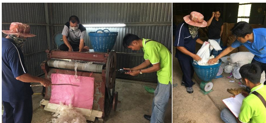
ภาพที่ 1.19 การทดสอบเก็บข้อมูลเครื่องทึบฝ้ายเป็นเครื่องที่นำเข้าจากต่างประเทศ
