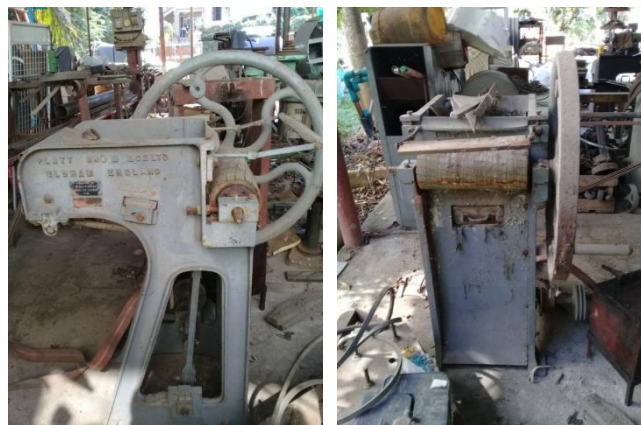
ภาพที่ 1.16 เครื่องหีบฝ้ายแบบมือหมุนรุ่นเก่าจากต่างประเทศ
