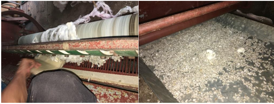
ภาพที่ 1.20 การตัดแยกเมล็ดออกจากปุยฝ้าย
