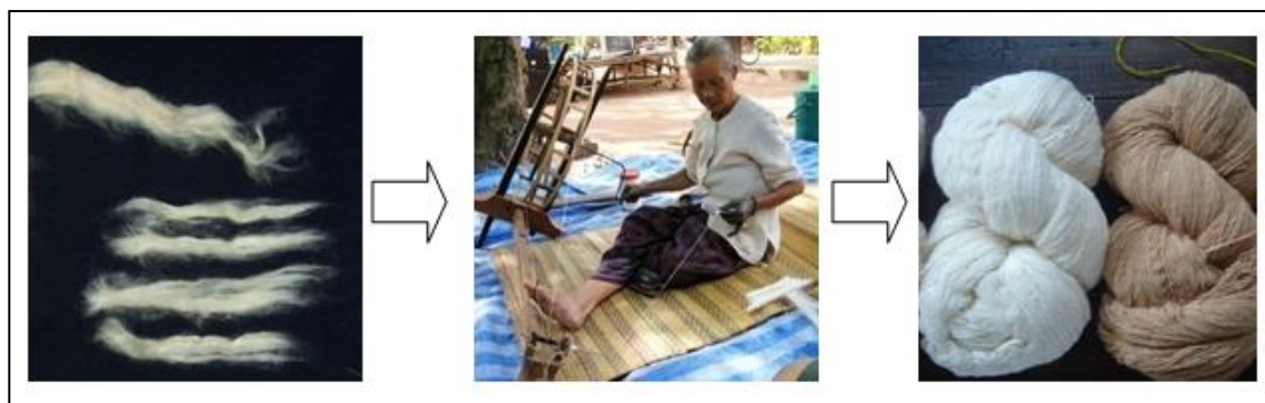
ภาพที่ 3.1 แสดงขั้นตอนการแปรรูปจากเส้นใยฝ้ายให้เป็นเส้นด้าย
