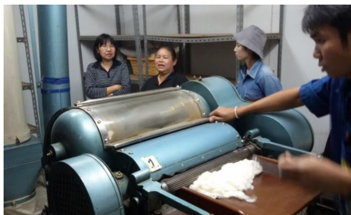
ภาพที่ 1.11 เครื่องทำความสะอาดปุยฝ้ายหลังจากการตัดแยกเมล็ดด้วยเครื่องทอฝ้าย ณ ศูนย์วิจัยพืชไร่นครสวรรค์
