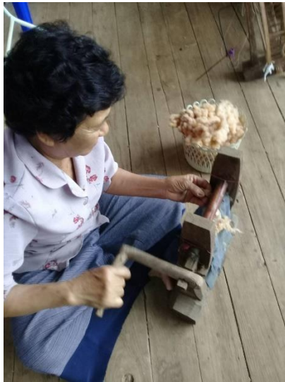
ภาพที่ 2.7 เครื่องแยกเมล็ดฝ้ายออกจากเนื้อฝ้าย (อีว)
