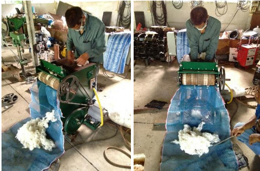
ภาพที่ 1.23 การทดสอบคัดแยกเม็ลต์ออกจากปุ๋ยฝ้ายด้วยเครื่องหีบฝ้ายขนาดเล็ก ในโรงปฏิบัติงาน ศวศ.ขอนแก่น
