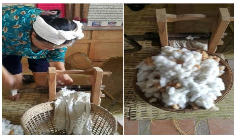
ภาพที่ 1.7 การใช้เครื่องทึบฝ้ายแบบมือหมุนหรือเรียกว่าการอ้วฝ้าย
