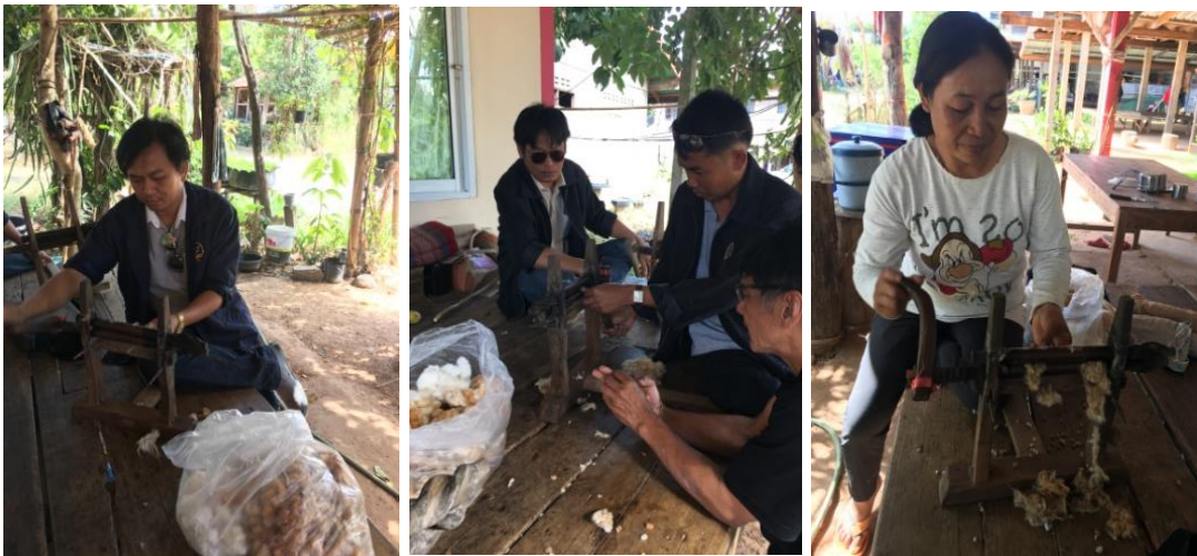
ภาพที่ 1.15 การทดลองหีบหรืออ้วฝ้ายด้วยเครื่องแบบมือหมุน
