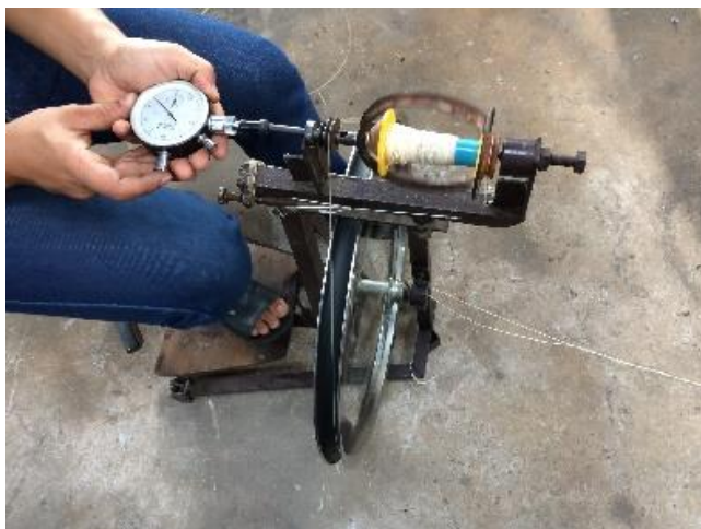
ภาพที่ 3.10 วัดความเร็วรอบในขณะที่ทำงานของหัวปั่นฝ้ายแบบเมเตลรีจักรา
