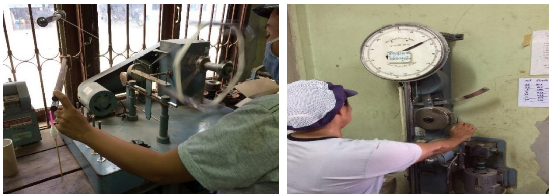
ภาพที่ 3.16 แสดงการทดสอบเส้นด้ายที่ได้จากการปั่นโดยอุปกรณ์ทดสอบตามมาตรฐาน ASTM
