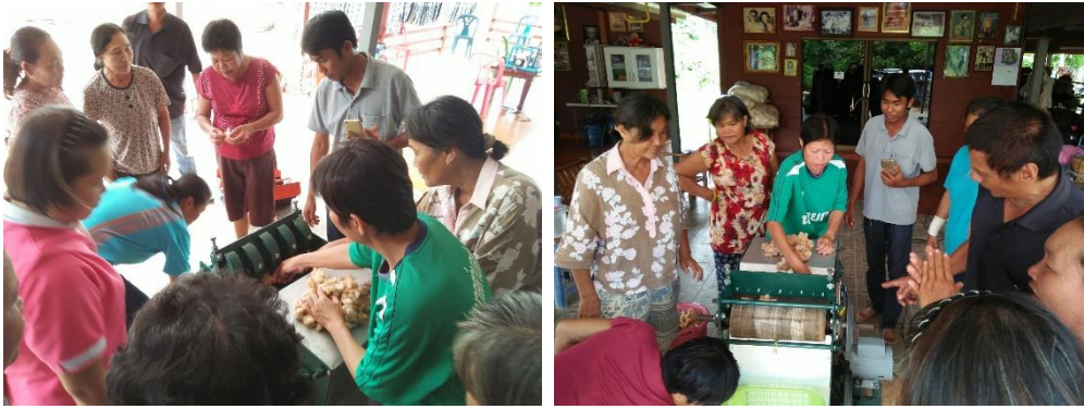
ภาพที่ 1.26 การทดสอบคัดแยกเมล็ดออกจากปุยฝ้ายด้วยต้นแบบเครื่องหีบฝ้ายขนาดเล็ก ร่วมกับกลุ่มแม่บ้าน ณ ศพก.หนองสูง จ.มุกดาหาร
