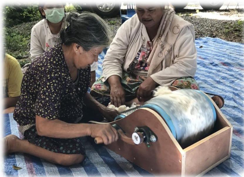
ภาพที่ 17 เกษตรกรทดสอบเครื่องสางฝ้ายต้นแบบตีฟูเส้นฝ้าย
