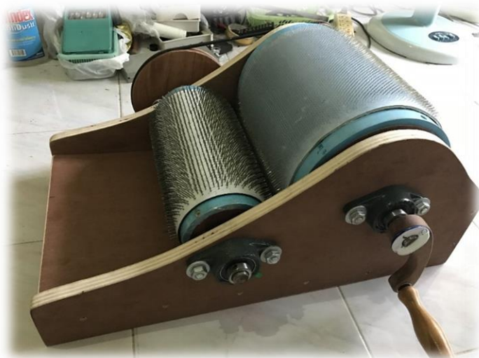
ภาพที่ 2.14 เครื่อง紡ฝ้าย ตัวต้นแบบ
