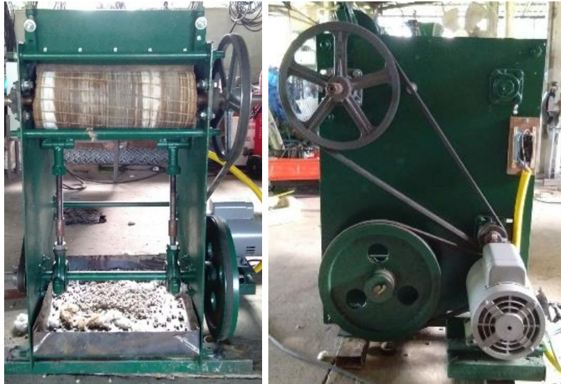
ภาพที่ 1.22 ต้นแบบเครื่องหีบฝ้ายขนาดเล็กสำหรับการคัดแยกเม็ลต์ออกจากปุ๋ยฝ้าย
