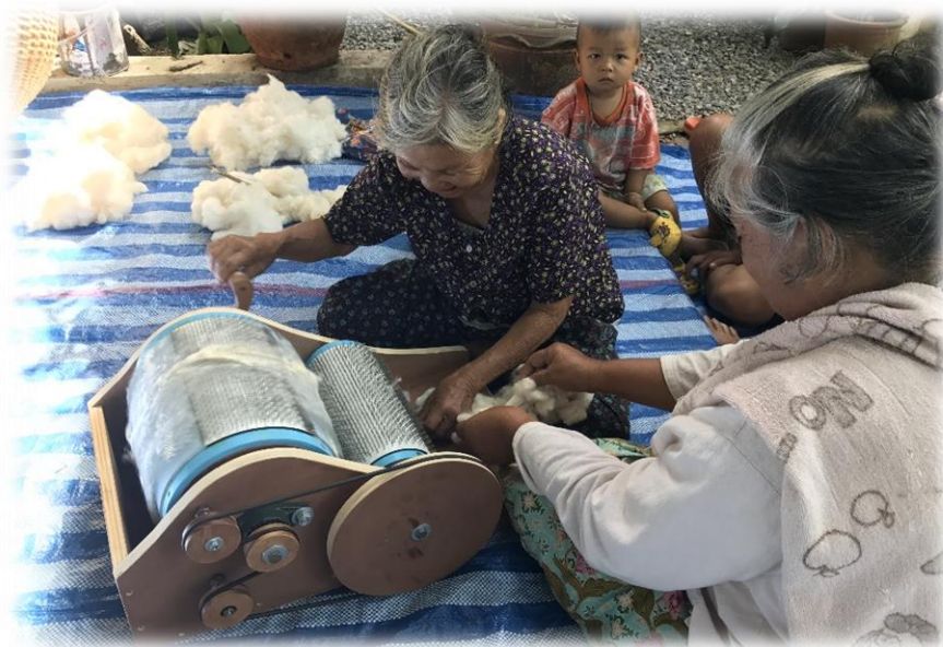
ภาพที่ 2.16 เครื่องสางฝ้ายต้นแบบดีดเส้นฝ้ายต่อครั้ง 25 กรัม
