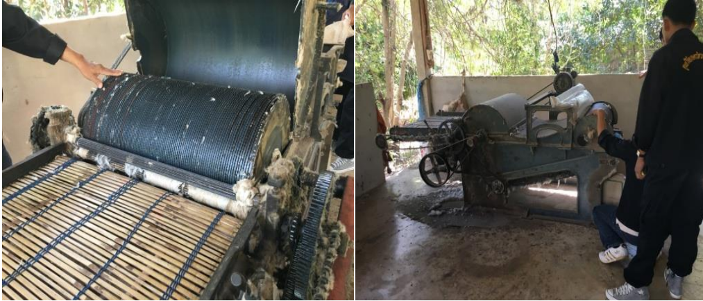
ภาพที่ 1.14 เครื่องทำความสะอาดฝ้ายที่ผ่านการหีบฝ้ายแล้ว
