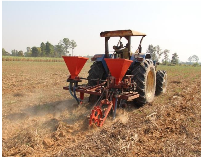
รูปที่ 2 เครื่องหยอดปุ๋ยผสมสำหรับอ้อยแบบ 2 แถว
