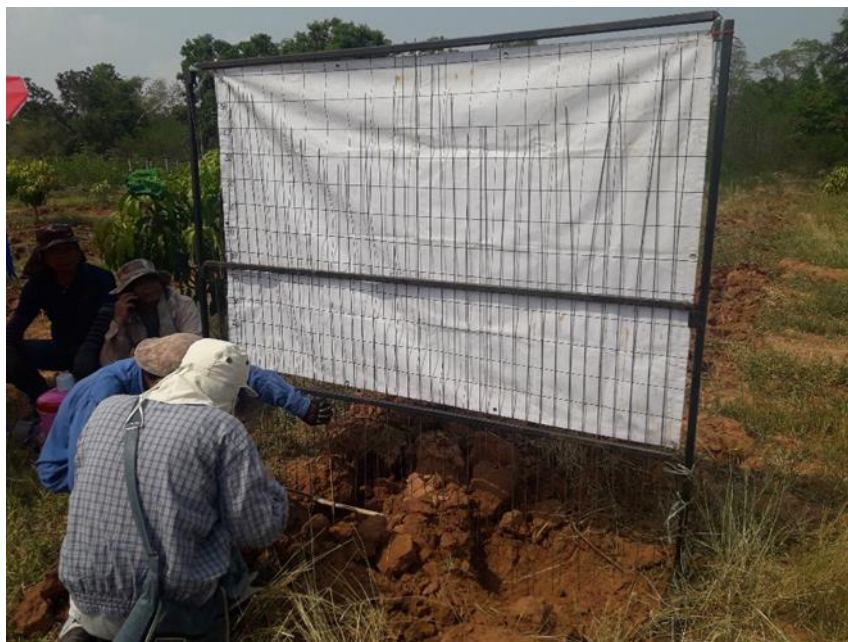
ภาพที่ 17 แสดงการวัดพื้นที่การแตกตัวของดินในส่วนที่เป็นหลุมโดยใช้ Profile meter
