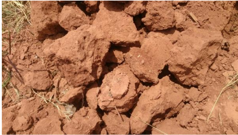
ภาพที่ 20 การแตกตัวของดินขณะชาไถไม่สั้น ความลึกในการไถ 30 เซนติเมตร ความเร็วในการเคลื่อนที่ Low 2
