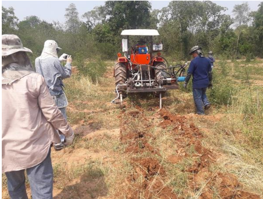
ภาพที่ 26 แสดงการทำงานของไถดินดานชนิดสันที่ขา 2 ขา แบบมีชุดควบคุมความถี่ในการสัน
