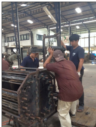
ภาพที่ 11 การติดตั้งลูกกลิ้งสำหรับม้วนใบ เข้ากับโครงสร้างหลัก
