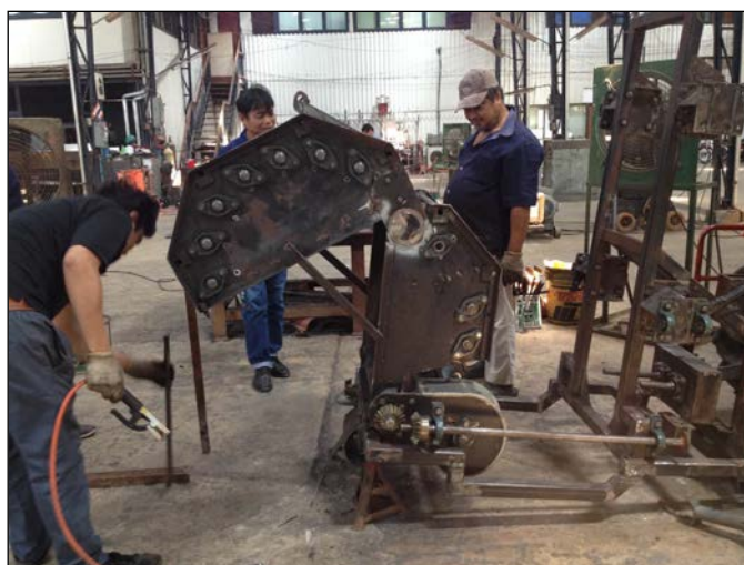
ภาพที่ 12 การประกอบชุดดึงใบอ้อยแห้งจากพื้นดิน เข้ากับห้องม้วนใบ
