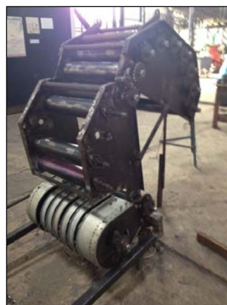
ภาพที่ 12 การประกอบชุดดึงใบอ้อยแห้งจากพื้นดิน เข้ากับห้องม้วนใบ
