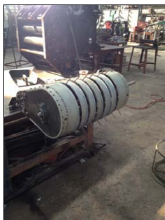
ภาพที่ 12 การประกอบชุดดึงใบอ้อยแห้งจากพื้นดิน เข้ากับห้องม้วนใบ
