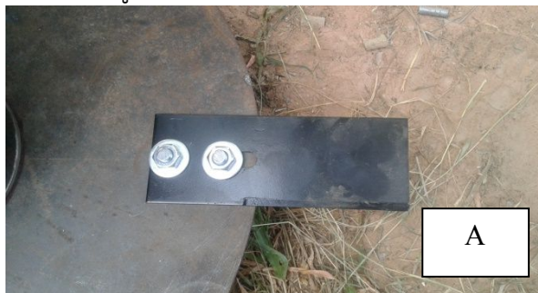
รูปที่ 4 ลักษณะใบมีดที่ใช้สำหรับการทดสอบตัดต่ออ้อย (A) ใบมีดแบบแบน (B) ใบมีดแบบวงเคียน
