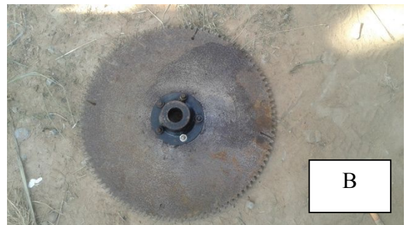
รูปที่ 4 ลักษณะใบมีดที่ใช้สำหรับการทดสอบตัดต่ออ้อย (A) ใบมีดแบบแบน (B) ใบมีดแบบวงเคียน
