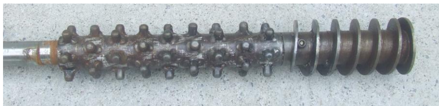
ภาพที่ 11 แกนขัดเปลือกถั่วเขียวผ่าซีกแช่น้ำแบบที่ 3
