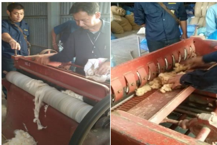
ภาพที่ 9 เครื่องทอฝ้ายแบบลูกกลิ้งเดี่ยว ณ ศูนย์วิจัยพืชไร่นครสวรรค์
