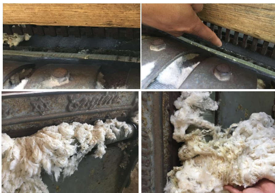
ภาพที่ 13 ปุยฝ้ายที่ผ่านการหีบด้วยเครื่องของโรงงานหีบฝ้าย
