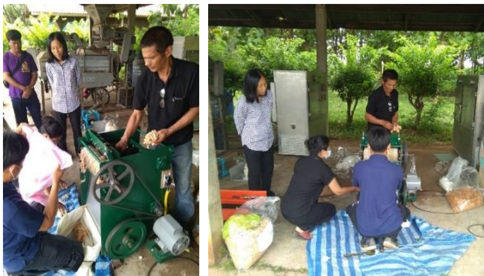
ภาพที่ 24 การทดสอบคัดแยกเมล็ดออกจากปุ๋ยฝ้ายด้วยเครื่องหีบฝ้ายขนาดเล็ก ณ ศพพ.มุกดาหาร
