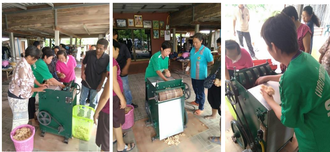
ภาพที่ 25 การทดสอบคัดแยกเมล็ดออกจากปุ๋ยฝ้ายด้วยเครื่องหีบฝ้ายขนาดเล็ก ร่วมกับกลุ่มแม่บ้าน ณ ศพก.หนองสูง จ.มุกดาหาร
