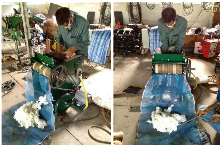
ภาพที่ 23 การทดสอบคัดแยกเมล็ดออกจากปุยฝ้ายด้วยเครื่องทอฝ้ายขนาดเล็ก ในโรงปฏิบัติงาน ศวศ.ขอนแก่น
