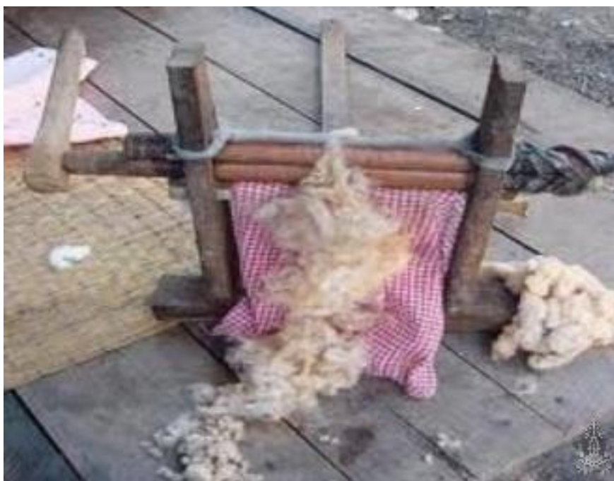
ภาพที่ 1 เครื่องหีบฝ้ายแบบลูกกลิ้ง ที่มา : ศูนย์ข้อมูลกลางทางวัฒนธรรม (2554)
