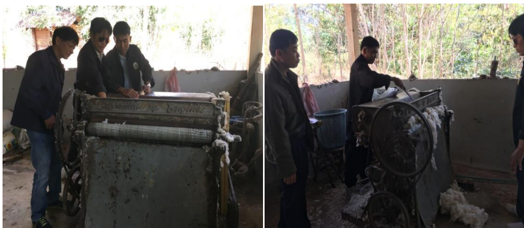
ภาพที่ 12 เครื่องหีบฝ้ายแบบลูกกลิ้งเดี่ยวของเกษตรกรจังหวัดมุกดาหาร
