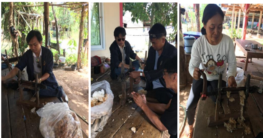
ภาพที่ 15 การทดลองหีบหรืออ้วฝ้ายด้วยเครื่องแบบมือหมุน
