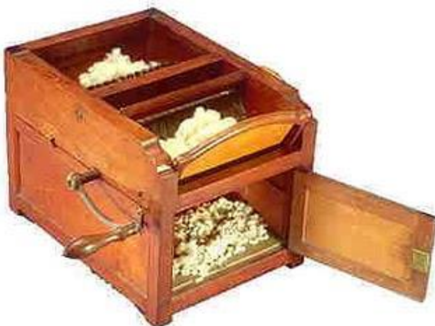
ภาพที่ 2 เครื่องหีบฝ้ายแบบฟันเลื่อย (saw gin) ที่มา : พิพิธภัณฑสถานผ้า มหาวิทยาลัยนเรศวร (2551)
