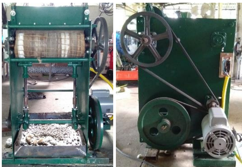
ภาพที่ 22 ต้นแบบเครื่องทอฝ้ายขนาดเล็กสำหรับการคัดแยกเมล็ดออกจากปุยฝ้าย
