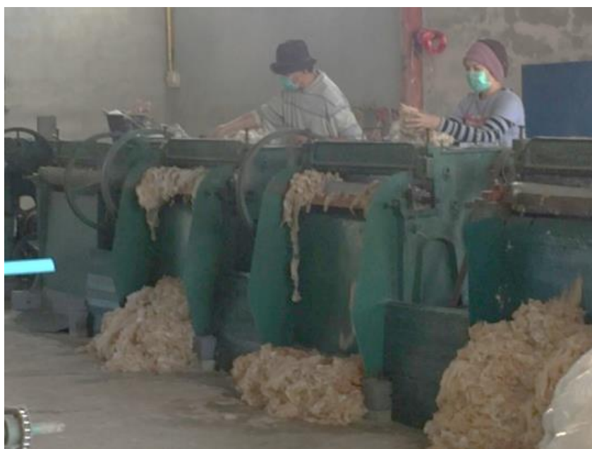
ภาพที่ 8 โรงงานรับจ้างทึบฝ้ายโดยใช้เครื่องจักรขนาดใหญ่
