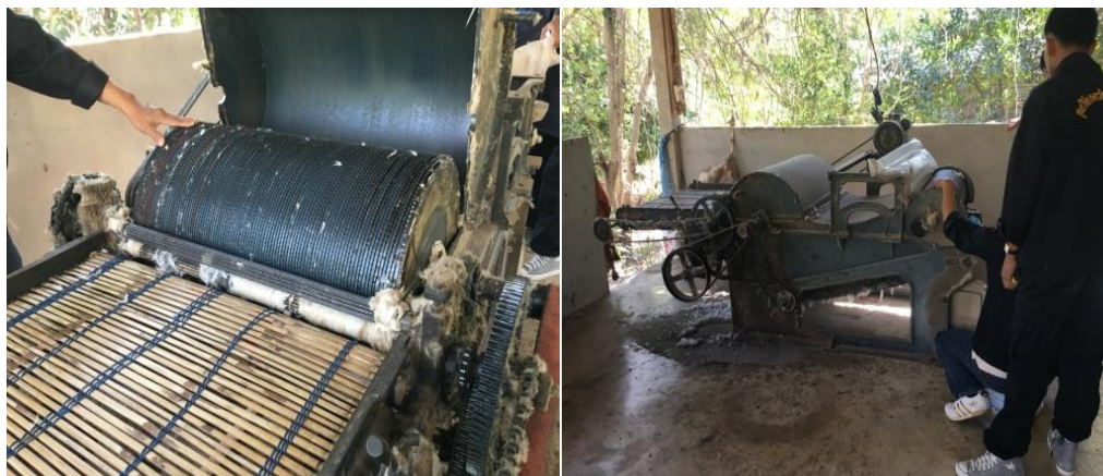
ภาพที่ 14 เครื่องทำความสะอาดฝ้ายที่ผ่านการหีบฝ้ายแล้ว
