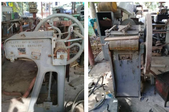
ภาพที่ 16 เครื่องทอฝ้ายแบบมือหมุนรุ่นเก่าจากต่างประเทศ
