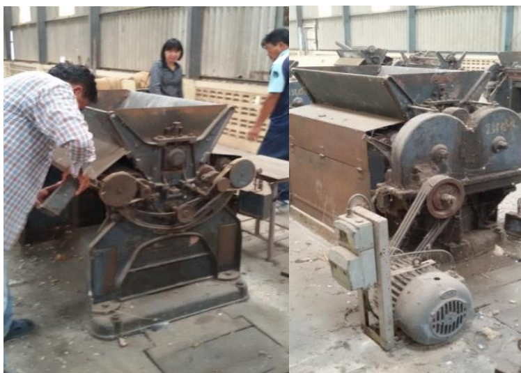
ภาพที่ 10 เครื่องทอฝ้ายแบบลูกกลิ้งคู่ ณ ศูนย์วิจัยพืชไร่นครสวรรค์
