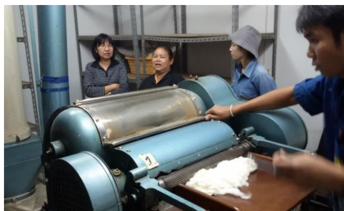
ภาพที่ 11 เครื่องทำความสะอาดปุยฝ้ายหลังจากการคัดแยกเมล็ดด้วยเครื่องทอฝ้าย ณ ศูนย์วิจัยพืชไร่นครสวรรค์
