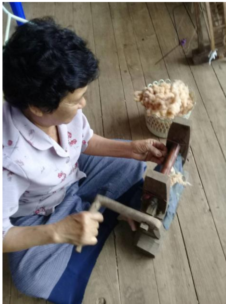
ภาพที่ 7 เครื่องแยกเมล็ดฝ้ายออกจากเนื้อฝ้าย (อ้าว)
