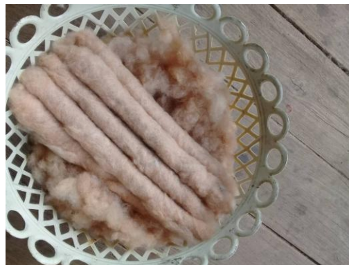
ภาพที่ 9 การม้วนเนื้อฝ้ายให้เป็นหลอด
