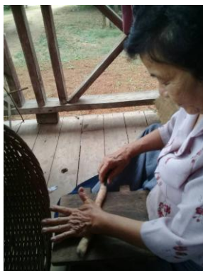
ภาพที่ 9 การม้วนเนื้อฝ้ายให้เป็นหลอด
