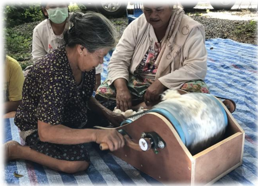
ภาพที่ 16 เกษตรกรทดสอบเครื่องสางฝ้ายต้นแบบตีฟูเส้นฝ้าย
