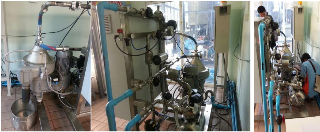
ภาพที่ 6 เครื่องปั่นเหวี่ยงแยกตะกอนความเร็วสูงแบบอัตโนมัติ
