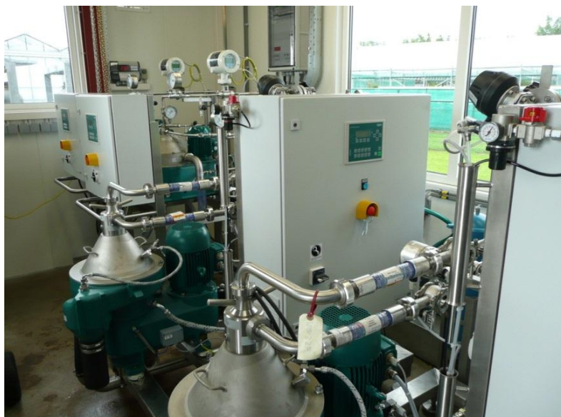
ภาพที่ 2 เครื่องเหวี่ยงแยกความเร็วสูงแบบต่อเนื่อง นำเข้าจากต่างประเทศ ที่มา : บริษัทจีอีเอเวสฟาเลียเซพพาเรเตอร์ (ประเทศไทย) จำกัด
