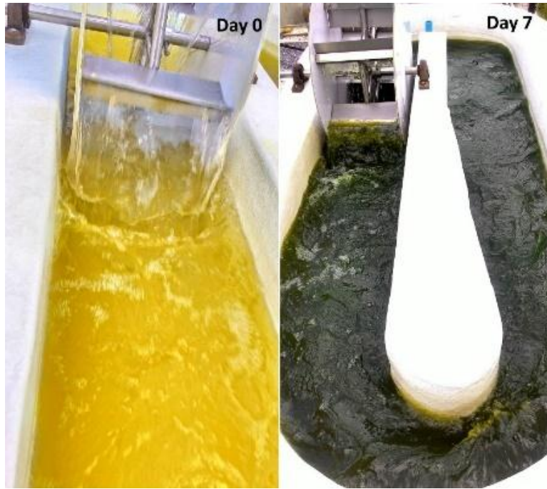
ภาพที่ 11 ลักษณะของการเพาะเลี้ยงสาหร่าย SK-QSGMF6 ในบ่อแบบเปิด (Open raceway pond)
