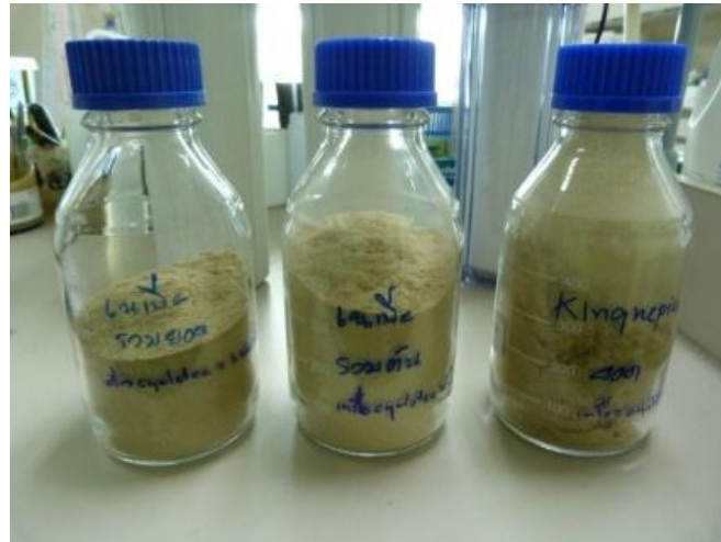
ภาพที่ 6 วัสดุชีวมวลที่ผ่านเครื่องบดละเอียดในห้องปฏิบัติการ
