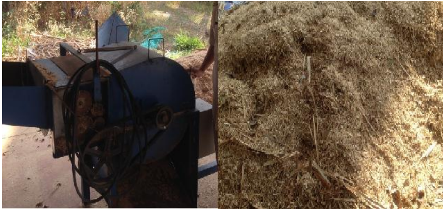
ภาพที่ 2 ทดสอบเครื่องมือแปรสภาพชีวมวลที่ได้จากการออกแบบของกรมวิชาการเกษตร
