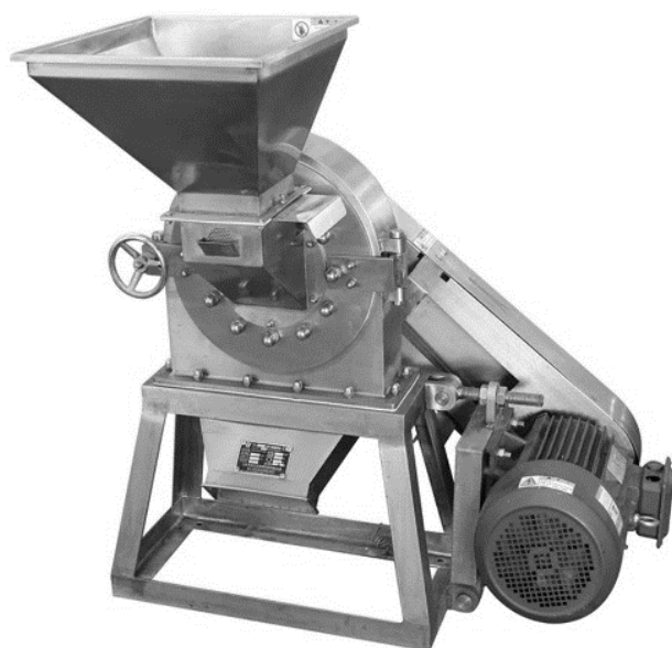
ภาพที่ 7 เครื่องบดแบบกระแทกที่ทำงานด้วยแรงกระแทก แรงเสียดสี แรงอัดและแรงเฉือน
