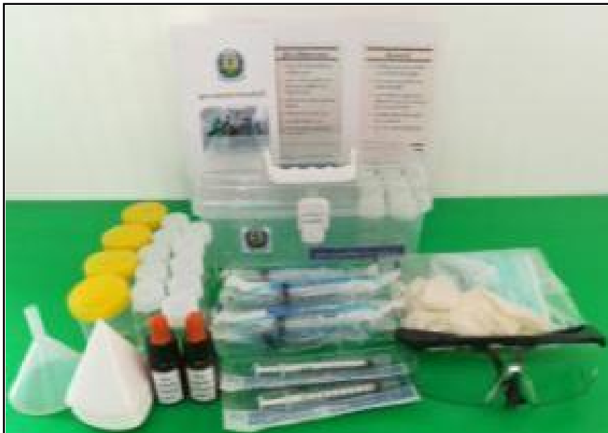
ภาพที่ 13 ชุดตรวจสอบไบคาร์บอเนตที่ได้พัฒนาขึ้น
