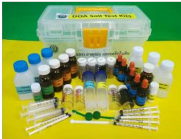
ภาพที่ 5 ชุดตรวจสอบอย่างง่ายวิเคราะห์แคลเซียม และแมกนีเซียม กำมะถัน และเหล็กในดิน
