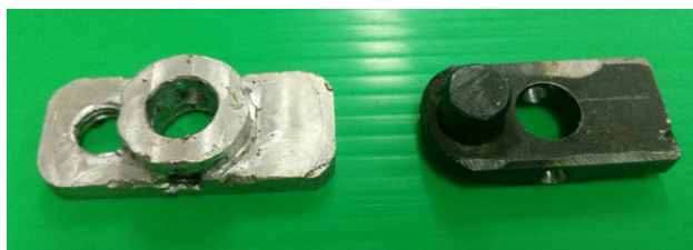
ภาพที่ 17 ลักษณะลูกเบี้ยวอลูมิเนียม (ซ้าย) และลูกเบี้ยวเหล็ก (ขวา) ของเครื่องตัดแต่งกิ่งแบบมอเตอร์เกียร์ทดกำลังและเลี้ยวซิก
