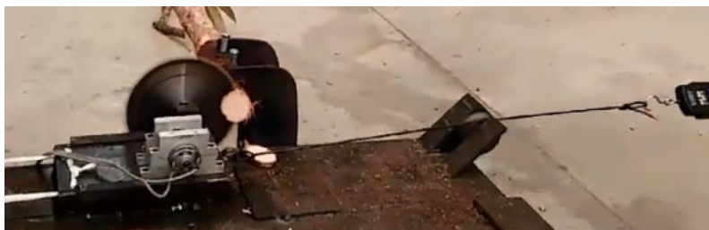
ภาพที่ 4 ชุดทดสอบความเร็วรอบในการตัดไม้ของเลื่อยวงเดือน (ใช้มอเตอร์ขนาดเล็ก)
