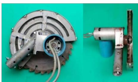
ภาพที่ 27 ตำแหน่งมอเตอร์แบบเดิมอยู่ที่หัวห้องเกียร์
