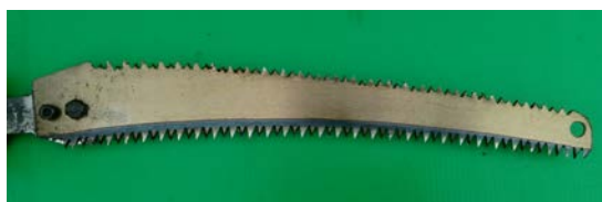
ภาพที่ 23 ลักษณะเลื่อยชักที่ทำการดัดแปลงให้มีฟันเลื่อยด้านบน
