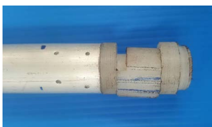
ภาพที่ 11 ลูกเบี้ยว (ทำจากซูเปอร์สตีล)
