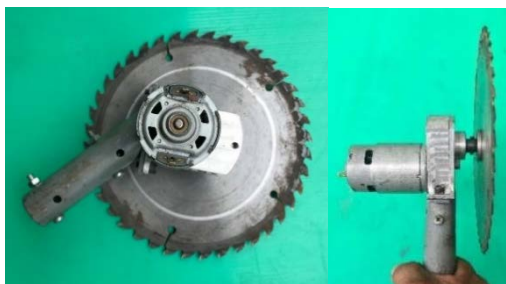
ภาพที่ 28 ตำแหน่งมอเตอร์ที่ปรับให้อยู่ด้านล่างห้องเกียร์
