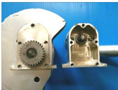
ภาพที่ 13 ห้องเกียร์เครื่องตัดแต่งกิ่งแบบมอเตอร์เกียร์ทดกำลังแบบเลื่อยวงเดือน
