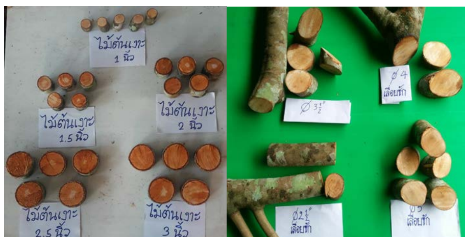
ภาพที่ 25 ลักษณะชิ้นไม้ที่ตัดด้วยเลี้ยววงเดือน (ซ้าย) และเลี้ยวซิก (ขวา)
