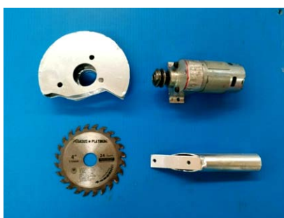
ภาพที่ 14 ส่วนประกอบของเครื่องตัดแต่งกิ่งแบบมอเตอร์เกียร์ทดกำลังแบบเลื่อยวงเดือน
