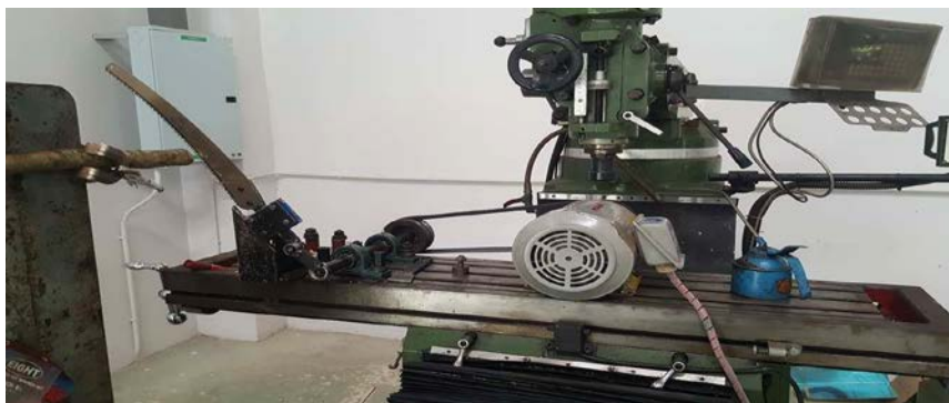
ภาพที่ 5 ทดสอบความถี่ในการชักที่เหมาะสมของเลื่อยชัก
