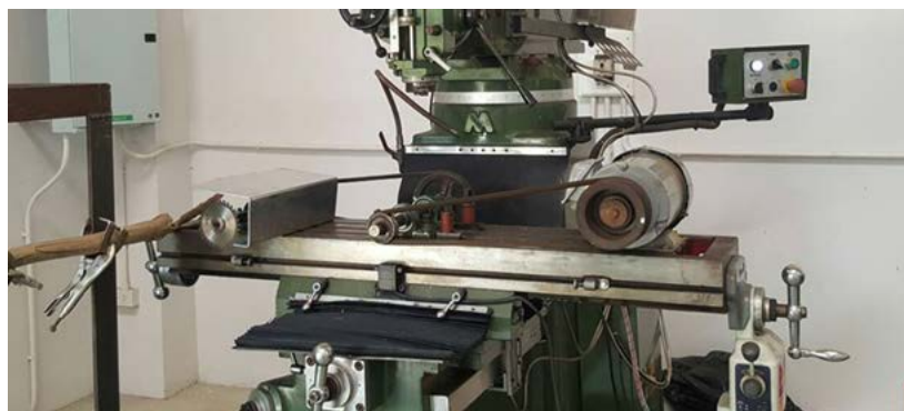
ภาพที่ 3 ทดสอบหาความเร็วรอบที่เหมาะสมของเลื่อยวงเดือน
