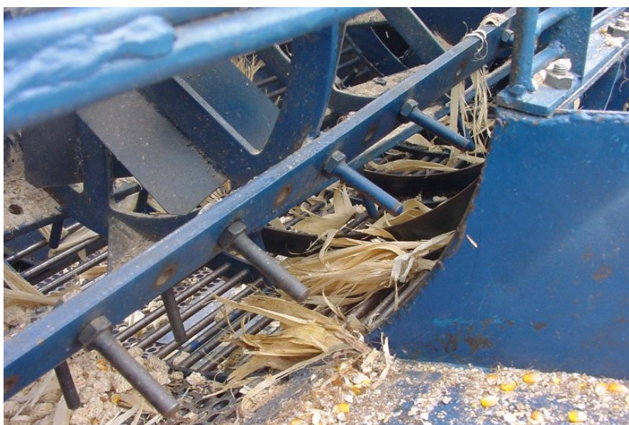
รูปที่ 17 ลักษณะซี่ฟันเครื่องนวดข้าวที่ใช้กะเทาะข้าวโพดทั้งเปลือก
