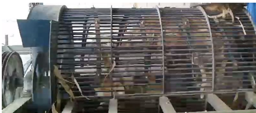
รูปที่ 15 ลักษณะการปรับครีบบหรือใบวงเดือน
