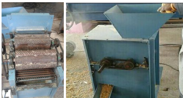
รูปที่ 8 ต้นแบบเครื่องกะเทาะข้าวโพดเลี้ยงสัตว์ แบบปอกเปลือกขนาดเล็ก 2 ลูก
