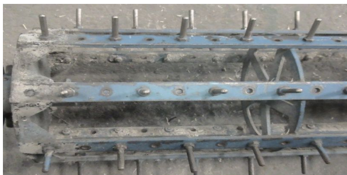
ภาพที่ 7 ลักษณะการถอดฟันลูกนวด แบบสลัก
