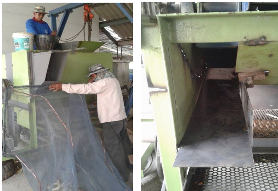
รูปที่ 16 ลักษณะช่องขับฟางที่แก้ไข เพื่อเก็บเปลือกข้าวโพด
