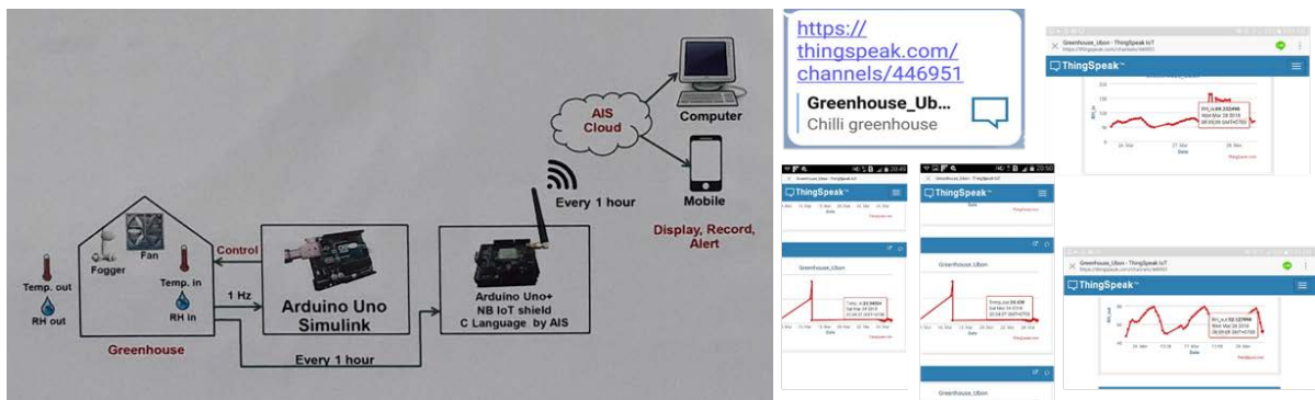
ภาพที่ 19 หลักการอ่านและส่งข้อมูล ผ่านระบบอินเทอร์เน็ตแห่งสรรพสิ่ง (Internet of Things, IoT)
