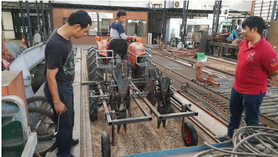
ภาพที่ 11 การทดสอบการทำงานของเครื่องปลูก
