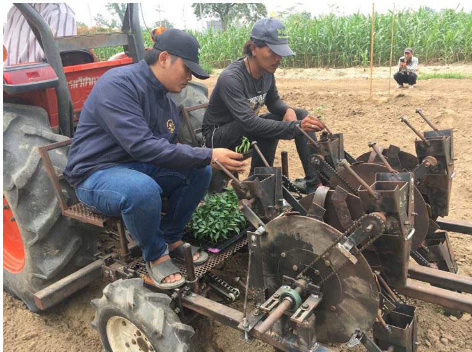
ภาพที่ 12(ก) การทดสอบการทำงานของเครื่องปลูกในแปลงทดลอง
