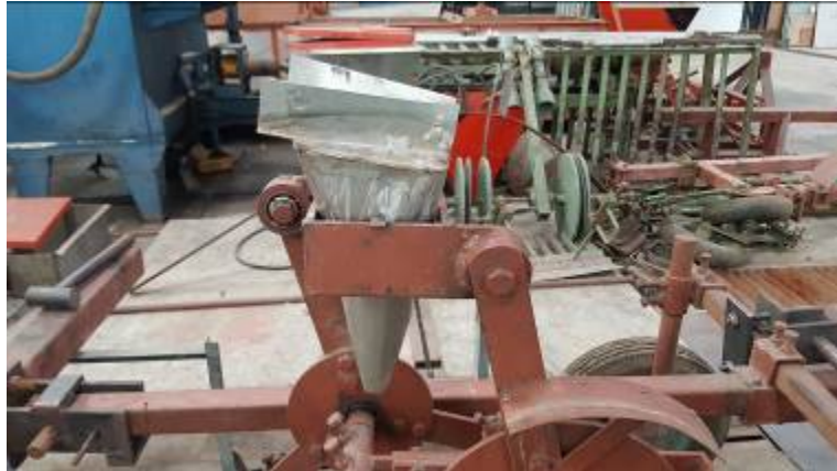
ภาพที่ 6 การประกอบถ้วยปลุกกับเครื่องปลุก
