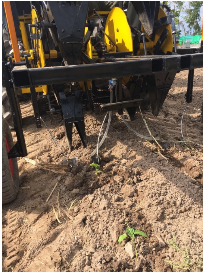
ภาพที่ 18 ชุดกลบดินและระบบรดน้ำ
