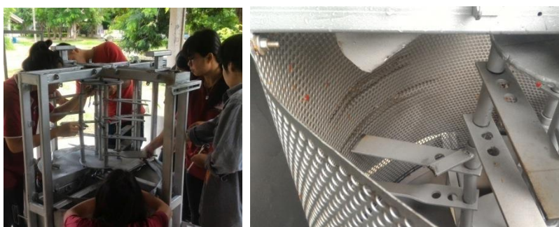
ภาพที่ 26 การโค้งตัวของเพล่า และการฉีดาของตะแกรง
