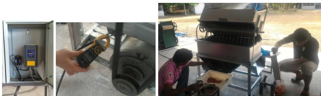
ภาพที่ 40 เครื่องปรับความเร็วรอบมอเตอร์ต้นกำลัง การวัดกระแสไฟฟ้า และการทดสอบการทำงานของเครื่องต้นแบบ
