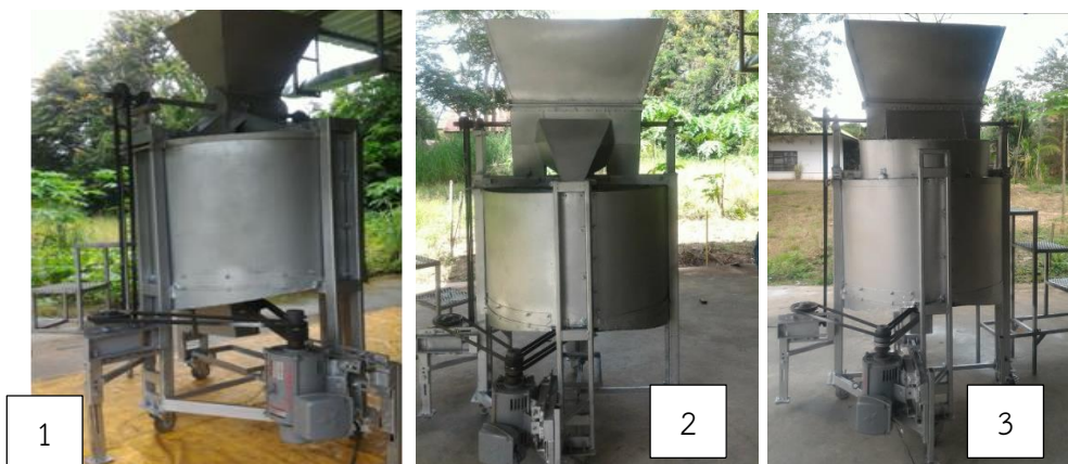
ภาพที่ 29 ชุดป้อนพริกเข้าเครื่องตีแยกเมล็ดพริกออกจากเปลือกที่ทำการแก้ไขล่าสุด (3)
