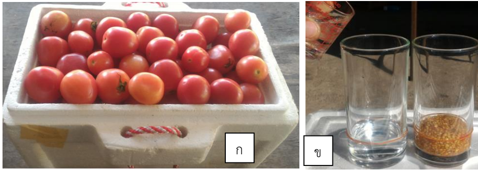
ภาพที่ 36 (ก) การวัดความหนาแน่นรวมผลมะเขือเทศ (ข) การวัดความหนาแน่นรวมของเมล็ดมะเขือเทศ
