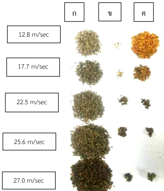
ภาพที่ 43 เปรียบเทียบเมล็ดมะเขือเทศหลังการแยกเนื้อออกที่แต่ละความเร็วของใบตีแยกเมล็ด ก) เมล็ดที่ผ่านตะแกรงและเข้าสู่ช่องรับเมล็ด ข) เมล็ดที่ตกค้ำงในตะแกรง ค) เมล็ดที่สูญเสียดูดไปกับเปลือกที่เข้าสู่ช่องรับเปลือก
