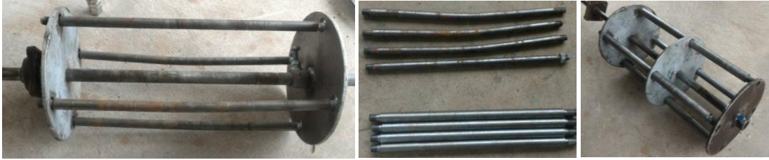
ภาพที่ 27 ก) การโค้งตัวของเพลาคีแยกเมล็ด ข) เพลาคเดิมและเพลาคใหม่ ค) การประกอบเพลาคใหม่และเหล็กหน้าแปลนยึดเพิ่มเพื่อความแข็งแรง
