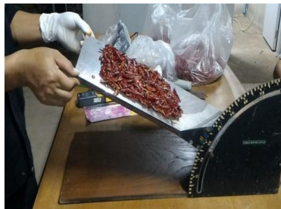
ภาพที่ 15 การใช้อุปกรณ์วัดมุมเทหรือมุมการไหลของพริกแห้ง
