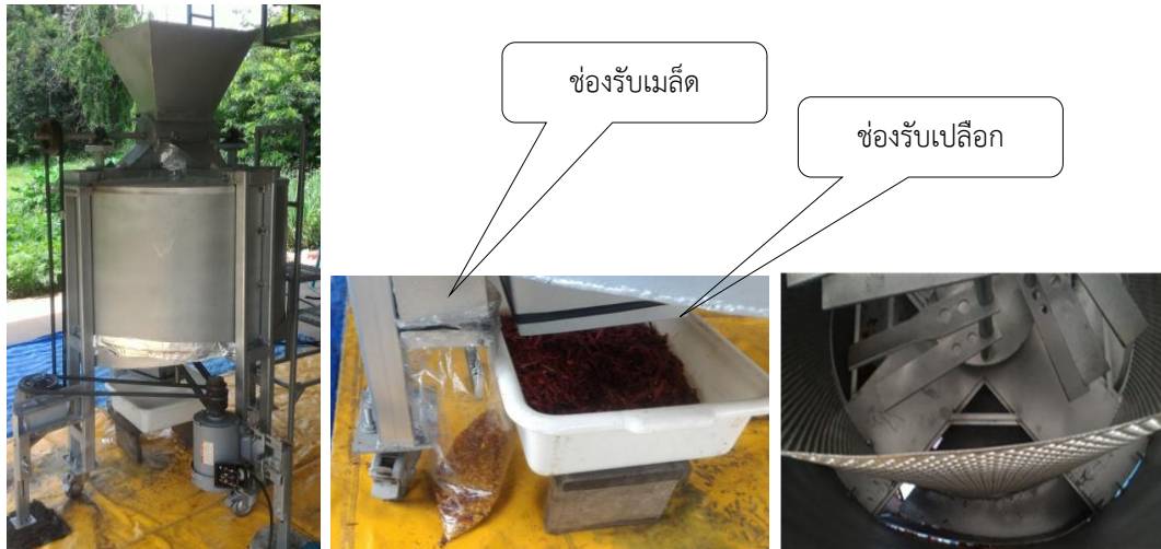
ภาพที่ 23 เครื่องต้นแบบที่สร้างชุดป้อนพริกด้านบน และภาพการตีแยกเมล็ด
