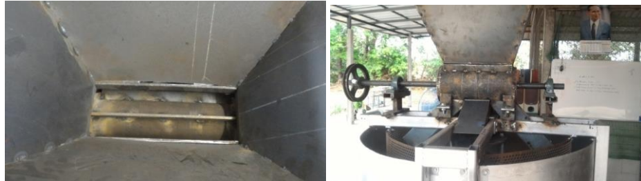
ภาพที่ 22 ชุดป้อนพริกแบบทรงกระบอกติดครีบบนเครื่อง แยกช่องป้อนพริกแบบสี่ช่อง
