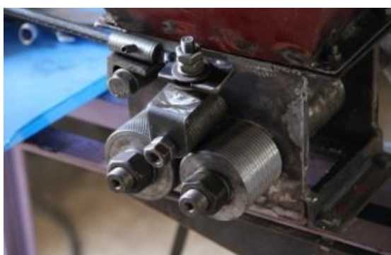
ภาพที่ 4 ชุดลูกกลิ้งขึ้นลายสำหรับกะเทาะเปลือกเม็ดบัว
