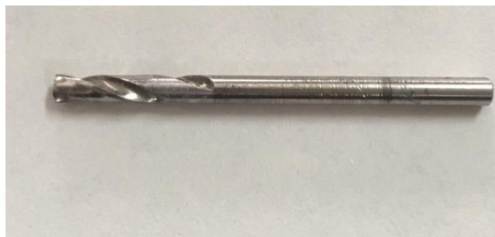
ภาพที่ 6 ดอกสว่านขนาดเส้นผ่าศูนย์กลาง 2.5 มิลลิเมตร
