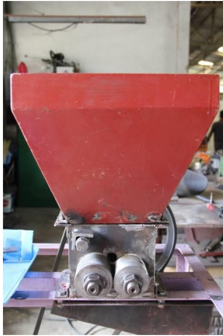
ภาพที่ 5 ต้นแบบเครื่องกะเทาะเปลือกเม็ดบัว
