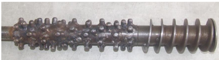
ภาพที่12 แกนขัดเปลือกถั่วเขียวผ่าซีกแช่น้ำแบบที่ 4
