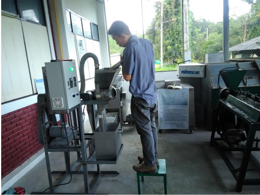
ภาพที่ 23 ทดสอบเก็บข้อมูลการใช้งานเครื่องคัดขนาดแป้งโดยใช้ลม ในการคัดขนาดแป้งบัวหลวง
