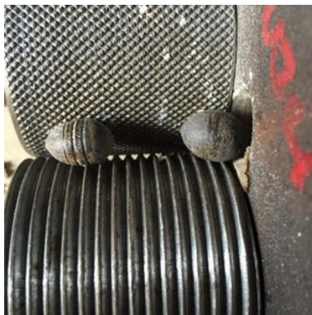
ภาพที่ 12 แสดงลักษณะของเปลือกเม็ตบัวที่ถูกกะเทาะโดยลูกกลิ้ง
