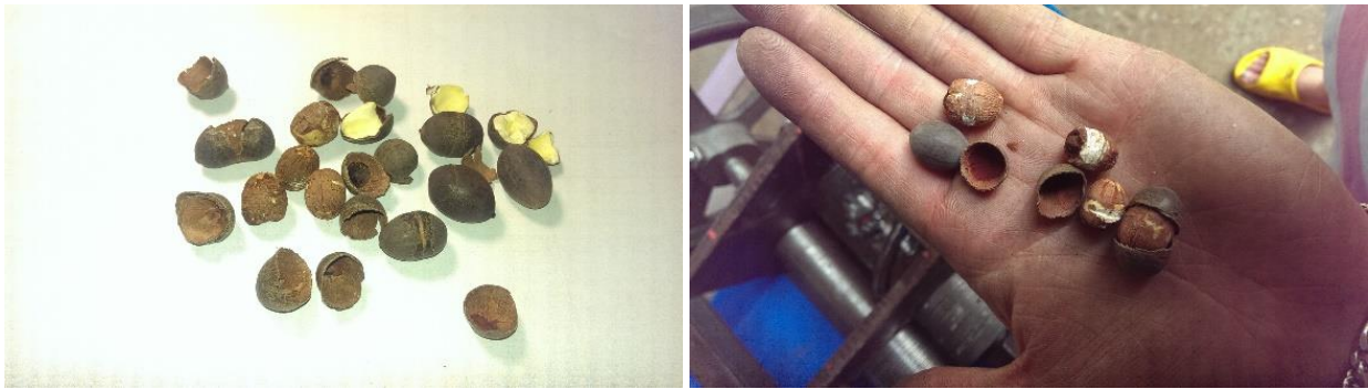
ภาพที่ 13 เม็ดบัวแห้งที่ผ่านการกะเทาะมีทั้งเม็ดที่กะเทาะได้สมบูรณ์ เม็ดที่ถูกบีบจนแตกเสียหายและเม็ดที่ไม่ถูกกะเทาะ
