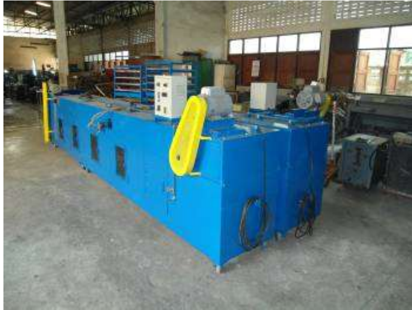
รูปที่ 11. เครื่องอบแห้งลมร้อนแบบต่อเนื่องต้นแบบ
