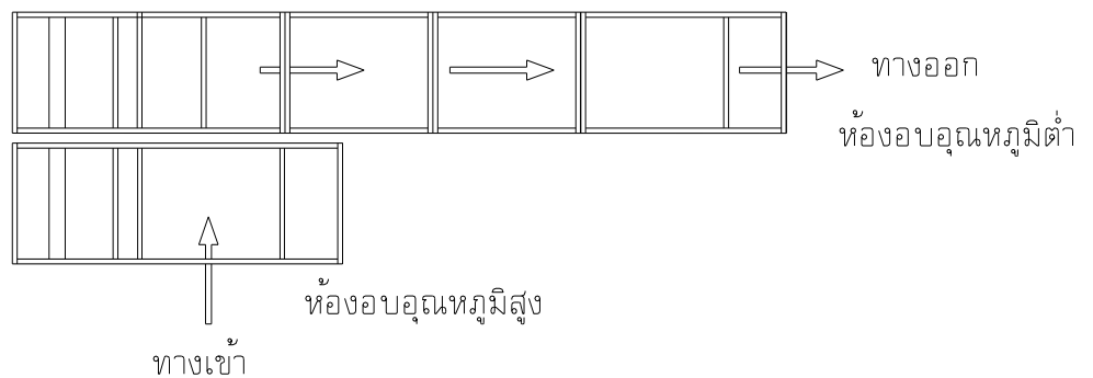
รูปที่ 20. รูปแบบการทำงานของเครื่องอบแห้งลมร้อนแบบต่อเนื่องต้นแบบ
