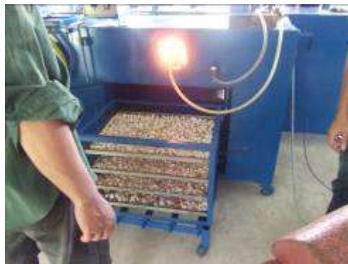
รูปที่ 21. ทดสอบอบแห้งเนื้อมังคุดด้วยเครื่องอบแห้งลมร้อนต้นแบบ
