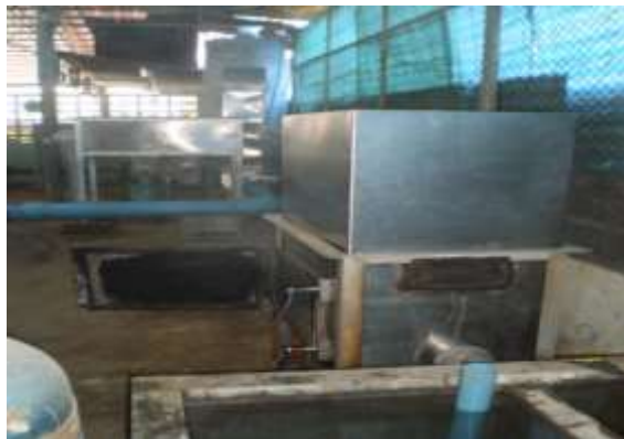
ภาพที่ 3 โรงรมแบบที่ 4 มีอุปกรณ์ช่วยในการหล่อเย็น
