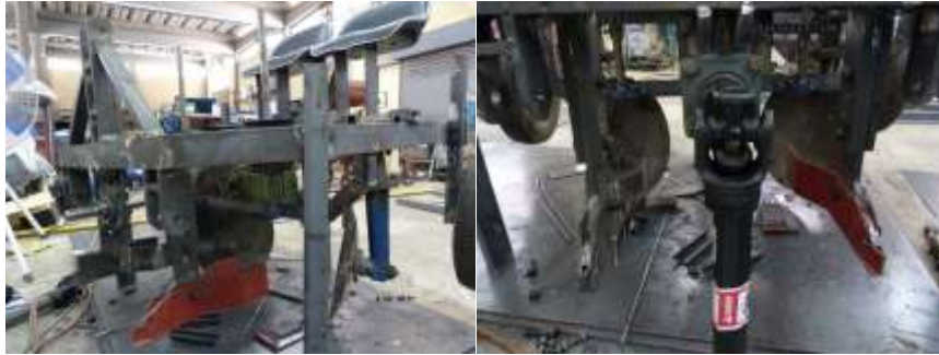
ภาพที่ 7 อุปกรณ์ป้อนหน่อสับปะรด และ โครงสร้างหลักของเครื่อง
