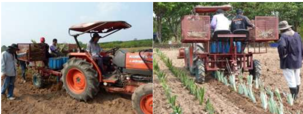
ภาพที่ 22 การคัดขนาดหน่อและบรรจุหน่อสับปรดของเครื่องปลูกฯ
