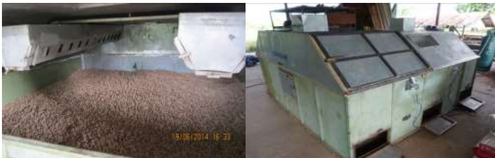
ภาพที่ 4 เครื่องอบแห้งแบบกระบะสลับทิศทางลมร้อนสำหรับทดสอบลดความชื้นฝักถั่วลิสง
