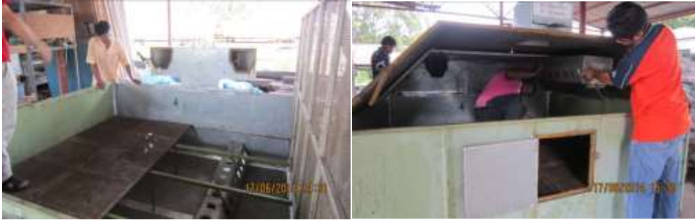
ภาพที่ 2 การติดตั้ง ประกอบเครื่องอบแห้งแบบกระบะสลับทิศทางลมร้อน (บน-ล่าง)
