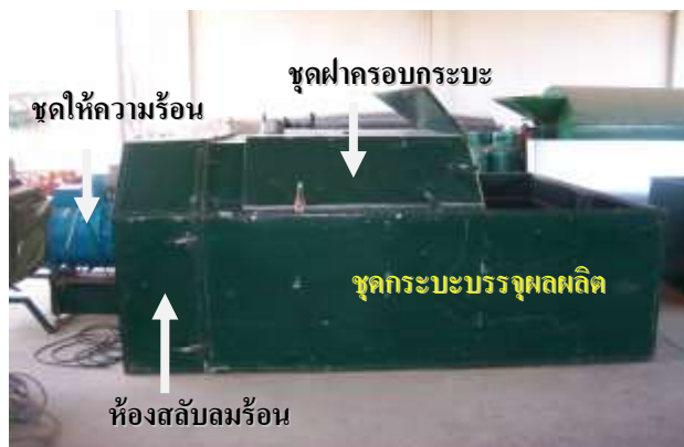
ภาพที่ 1 ส่วนประกอบของเครื่องอบแบบกระบะที่สามารถสลับลมร้อนได้
