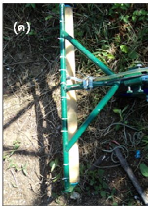
ภาพที่ 2 ต้นแบบเครื่องลูบวัชพืช 3 แบบ คือ ใช้ผ้าเช็ดเท้า (ก) ใช้ผ้ามีอบที่มีริ้ว (ข) และลูกกลิ้งทาสี (ค)
