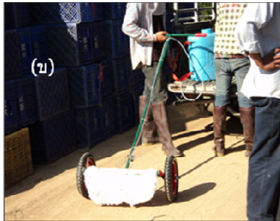
ภาพที่ 2 ต้นแบบเครื่องลูบวัชพืช 3 แบบ คือ ใช้ผ้าเช็ดเท้า (ก) ใช้ผ้ามีอบที่มีริ้ว (ข) และลูกกลิ้งทาสี (ค)
