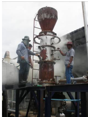
ภาพที่ 3.6.2 ทดสอบเตา Downdraft Gasifier และทดสอบจุดไฟจากแก๊สที่ได้
