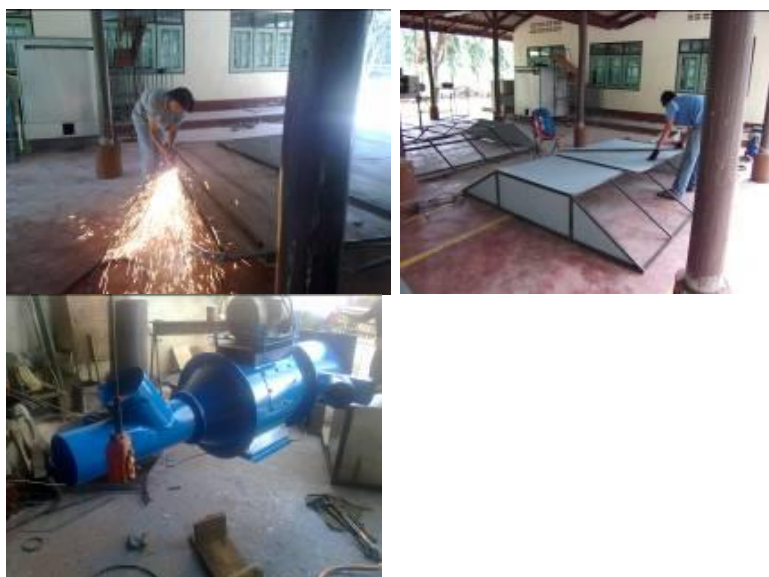
ภาพที่ 3.4.1 การประกอบโครงห้องอบละลายปาล์ม การติดตั้งผนังห้องอบและชุดพัดลม
