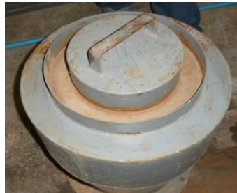
ภาพที่ 3.6.1 ถังบรรจุกะลาปาล์มดิบพร้อมซี้สน้ำ (ซ้าย) และส่วนอบแห้งช่วงไพโรไลซิสและเผาไหม้ (ขวา)
