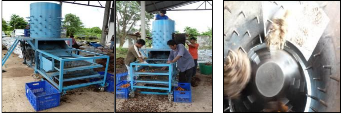
ภาพที่ 3.5.3 การทดสอบเครื่องต้นแบบ และลักษณะภายในถังแยกของเครื่องขณะผลิตผล
