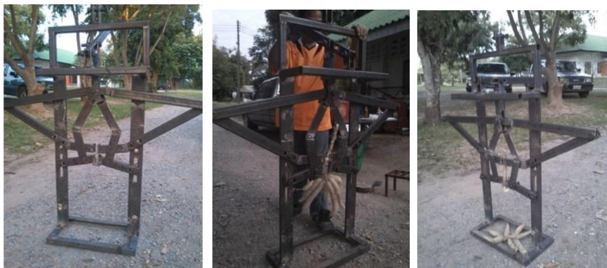
รูปที่ 22 ต้นแบบที่ 1 ที่สร้างจากกลไกแบบที่ 4 และการทดสอบการปลิดหัวมันออกจากเหง้า
