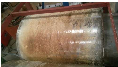
รูปที่ 26 การสะสมของกากมันที่เหลืจากการปาดของใบมีด
