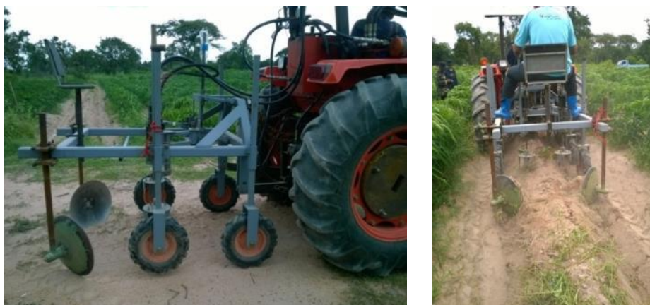
รูปที่ 14 เครื่องกำจัดวัชพืชต้นแบบและการทดสอบเบื้องต้น
