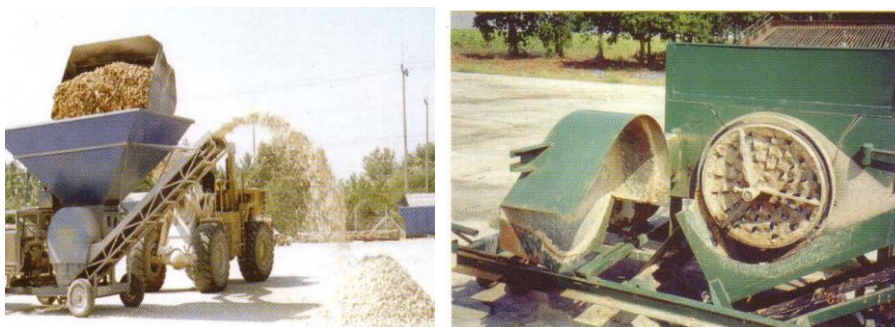
รูปที่ 1.1 เครื่องโม่มันเส้นขนาดใหญ่และขนาดกลาง
