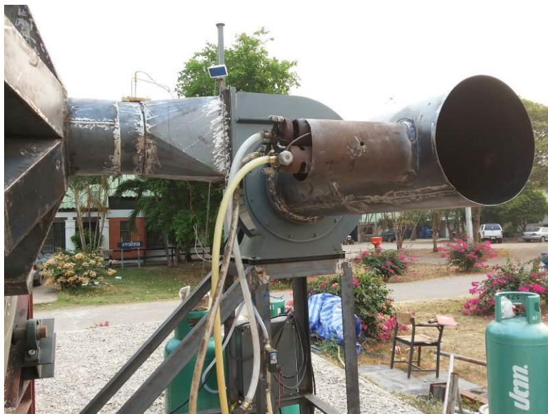
รูปที่ 2.14 พัฒนแบบแรงเหวี่ยงหนีศูนย์กลาง แก๊สหุงต้ม(LPG) สำหรับลมร้อนในการอบแห้ง
