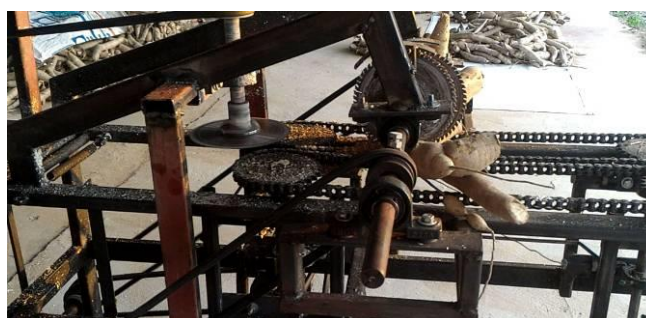
รูปที่ 36 การติดตั้งของหุ้มมันในใบเลื่อยด้านข้างเครื่องต้นแบบหลังจากที่ย้ายใบเลื่อยหลังให้อยู่ด้านบน
