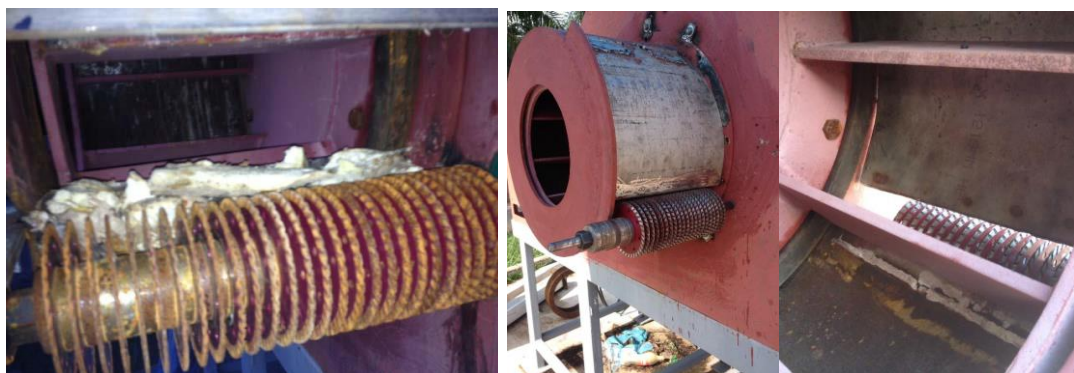
รูปที่ 1.11 ชุดใบมีดสับมันสำหรับหลังที่ทำให้เป็นเส้น
