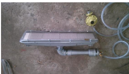
รูปที่ 20 หัวเผาก๊าซแอลพีจีแบบอินฟราเรดมาเป็นตัวให้ความร้อนแทนจากการทดสอบเบื้องต้นทำการวัดค่าอุณหภูมิ
