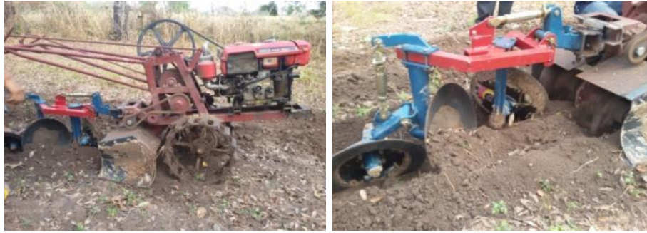
รูปที่ 10 เครื่องมือกำจัดวัชพืชในร่องมันฯ แบบเดินตาม ต้นแบบตัวที่ 2
