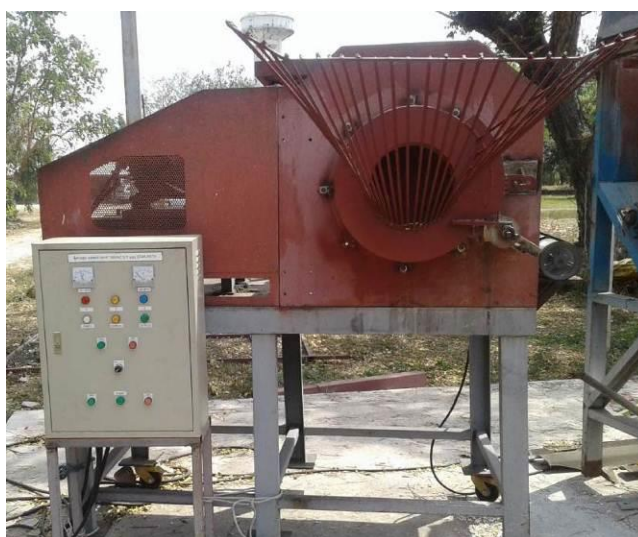
รูปที่ 1.23 เครื่องต้นแบบสับมันสำปะหลังให้เป็นแบบเต๋า
