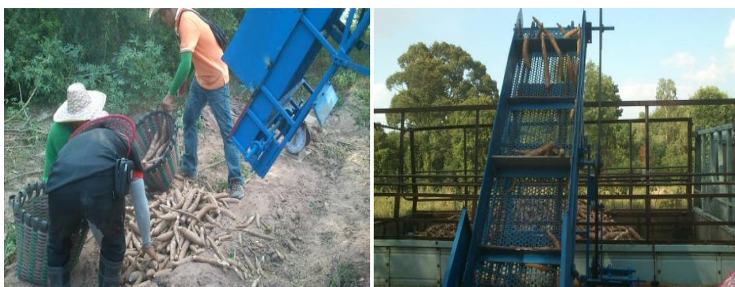
รูปที่ 11 การทดสอบเครื่องขนย้ายหัวมันสำปะหลังทดสอบที่ ศวพ.ภาพสินธุ์
