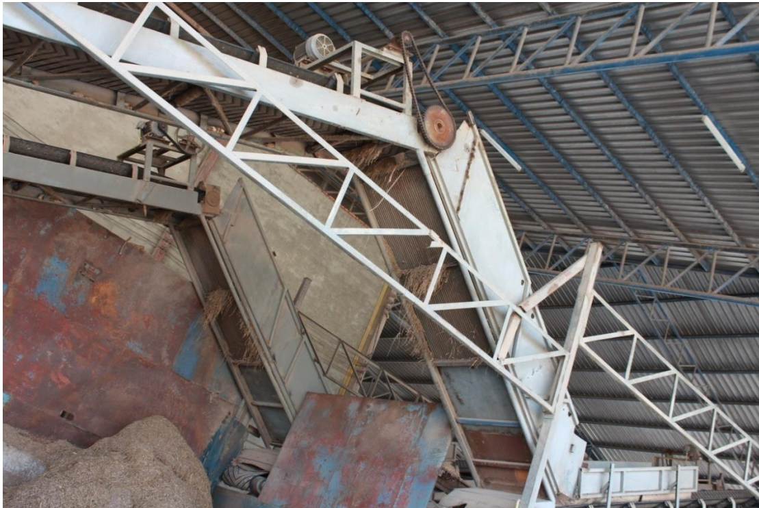
รูปที่ 7 ส่วนที่เป็นตะแกรงร่อนสำหรับทำความสะอาด
