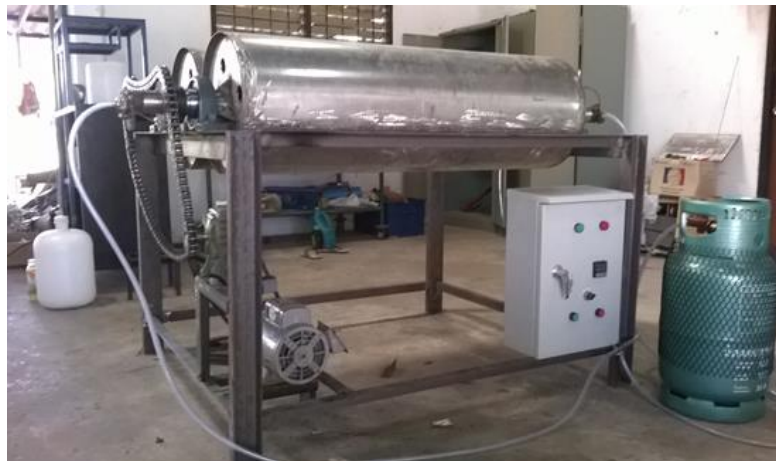
รูปที่18 เครื่องต้นแบบเครื่องลดความชื้นกากมันสำปะหลังแบบลูกกลิ้งคู่
