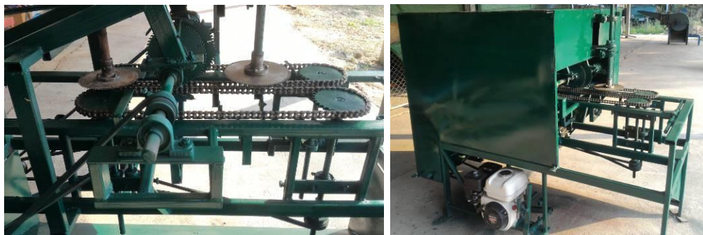
รูปที่ 39 เครื่องต้นแบบที่ 2 ที่เพิ่มใบเลื่อยด้านหลัง และเครื่องต้นแบบที่ประกอบโครงป้องกัน
