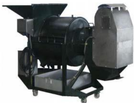
รูปที่ 1.4 เครื่องสับมันเส้นที่มหาวิทยาลัยเทคโนโลยีภาคตะวันออกเฉียงเหนือและลักษณะชิ้นมันที่ผ่านการสับ
