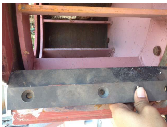
รูปที่ 1.9 ลักษณะใบมีดสับมันสำปะหลังที่นำมาเปลี่ยนเพื่อการทดสอบ
