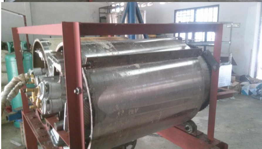
รูปที่22 เครื่องต้นแบบเครื่องลดความชื้นกากมันสำปะหลังแบบลูกกลิ้งคู่
