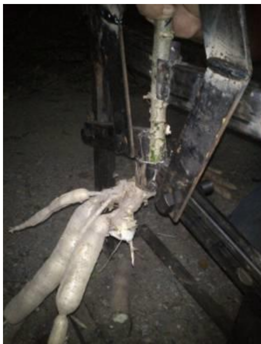
รูปที่ 24 ลักษณะหัวมันที่เยื้องศูนย์ทำให้ยากในการจับยึดด้วยหัวจับของเครื่องต้นแบบที่ 1
