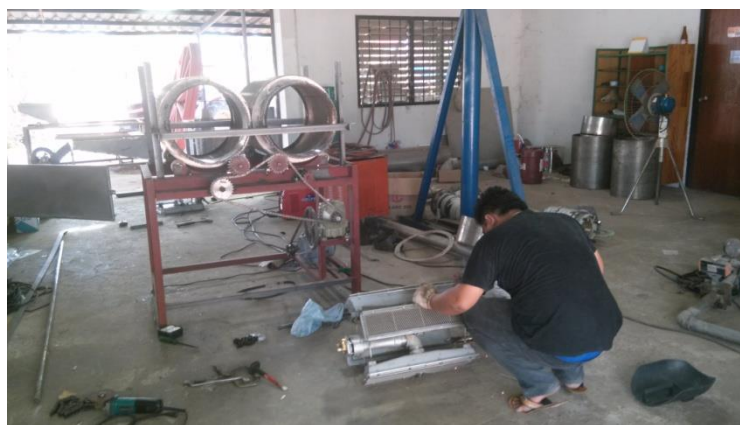
รูปที่24 การประกอบหัวเตาอินฟราเรดเข้าด้วยกัน
