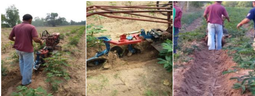
รูปที่ 10 เครื่องมือกำจัดวัชพืชในร่องมันฯ แบบเดินตาม ต้นแบบตัวที่ 2
