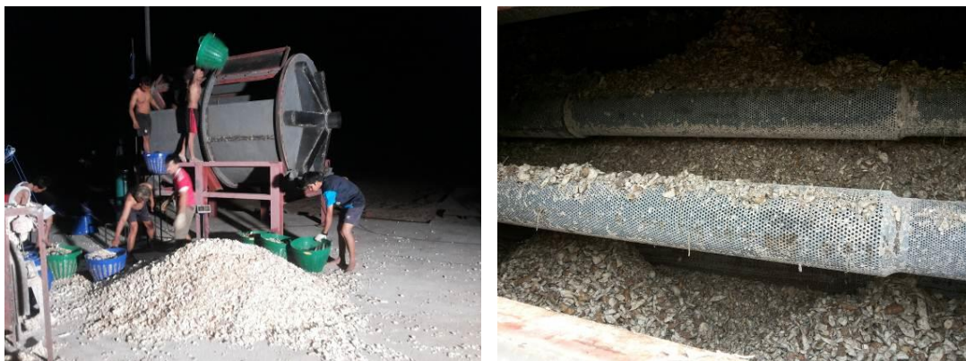
รูปที่ 2.16 การทดสอบการอบแห้งมันเส้นด้วยเครื่องอบแบบโรตารี
