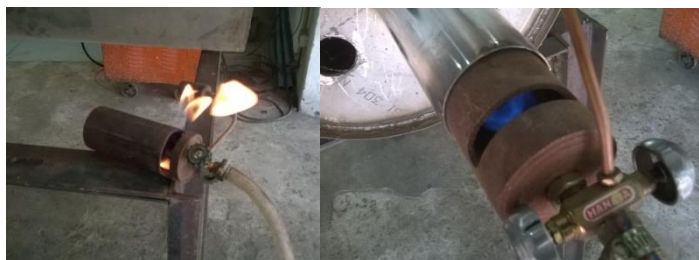
รูปที่19 หัวเผาแก๊สแอลพีจีแบบใช้ในตู้อบแบบอุโมงค์
