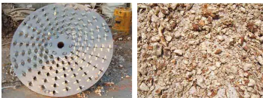
รูปที่ 1.2 ลักษณะจานหมุนและชิ้นมันสำปะหลังที่ผ่านการสับ
