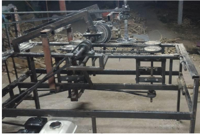
รูปที่ 38 เครื่องต้นแบบที่ย้ายใบเลื่อยหลังมาด้านหน้า และกลับทิศการหมุนตัดใบเลื่อยด้านซ้าย
