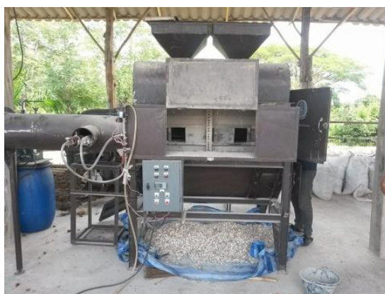
รูปที่ 2.6 การอบแห้งมันเส้นที่อุณหภูมิ 70 °C ด้วยเครื่องอบแห้งแบบโรตารี
