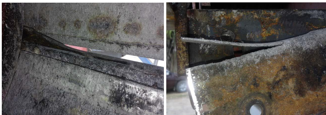
รูปที่ 1.8 ลักษณะใบมีดที่เกิดจากการเสียหายจากเหง้ามันสำปะหลังที่ติดมากับหัวมัน
