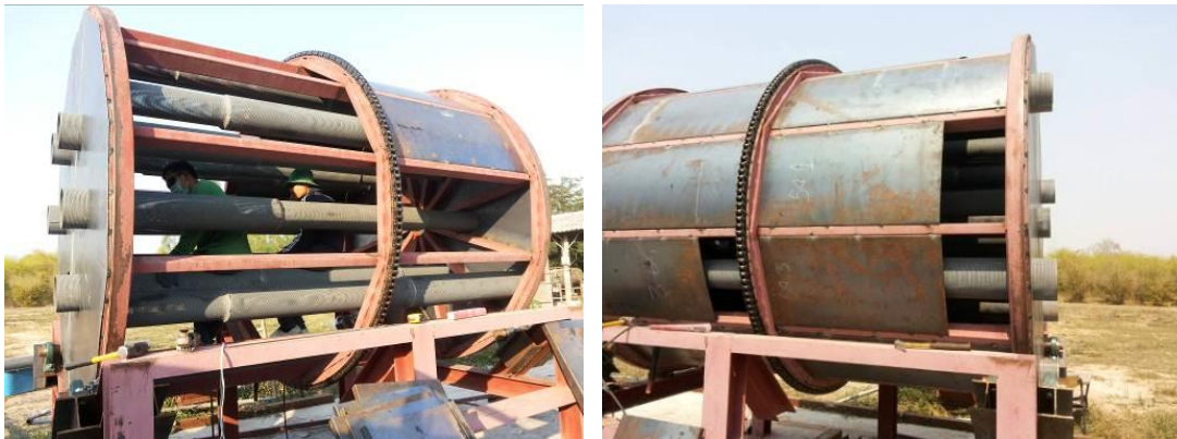
รูปที่ 2.12 การติดตั้งท่อกระจายลมร้อนภายในถังอบ
