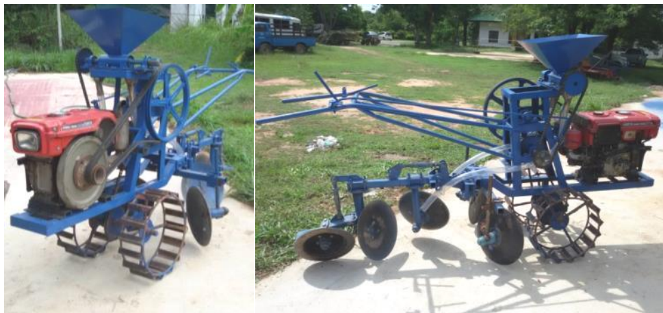
รูปที่ 13 ต้นแบบเครื่องกำจัดวัชพืชพร้อมยกร่องกลบปุ๋ยในร่องมันสำปะหลังแบบเดินตาม
