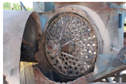
รูปที่ 9 เครื่องสับมันเส้น ใบสับเป็นแบบจานหมุน
