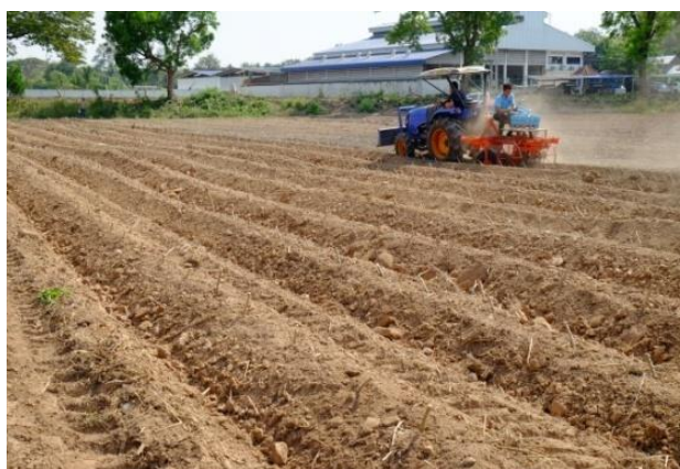
รูปที่ 10 ทดสอบเครื่องปลูกลำไยในพื้นที่ย่างกุ้ง จ.พิษณุโลก
