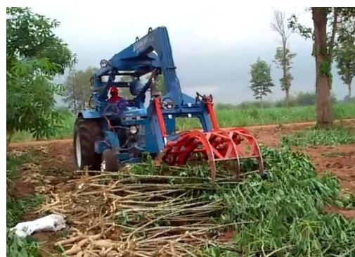
รูปที่ 12 การเก็บต้นมันหลังการปลิดด้วยรถคีบอ้อย
