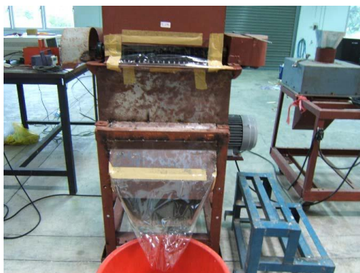
รูปที่ 1.5 เครื่องสับมันเส้นที่มหาวิทยาลัยเกษตรศาสตร์พัฒนาขึ้นและลักษณะชิ้นมันที่ผ่านการสับ
