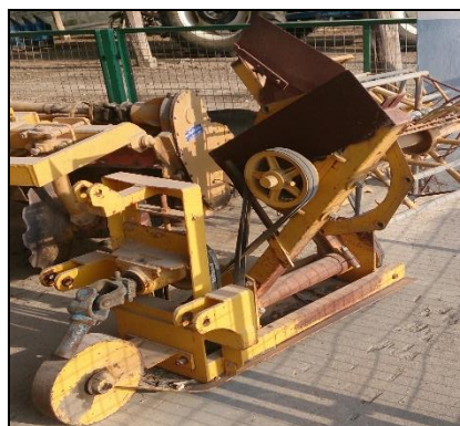
รูปที่ 2 เครื่องสางใบอ้อยติดตั้งกับรถแทรกเตอร์ขนาดเล็ก
