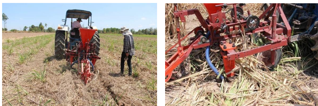
รูปที่ 3 การทดสอบการทำงานเบื้องต้น ใบอ้อยสะสมเนื่องจากสับใบไม่ขาด
