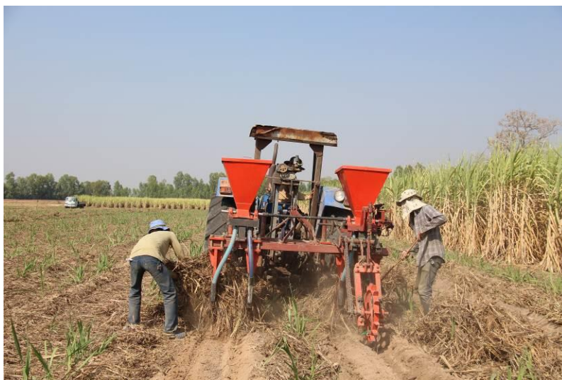
รูปที่ 10 สภาพที่ใบอ้อยสะสมในแปลงจำนวนมากได้ต้องหยุดทำงานเพื่อเอาใบอ้อยออก
