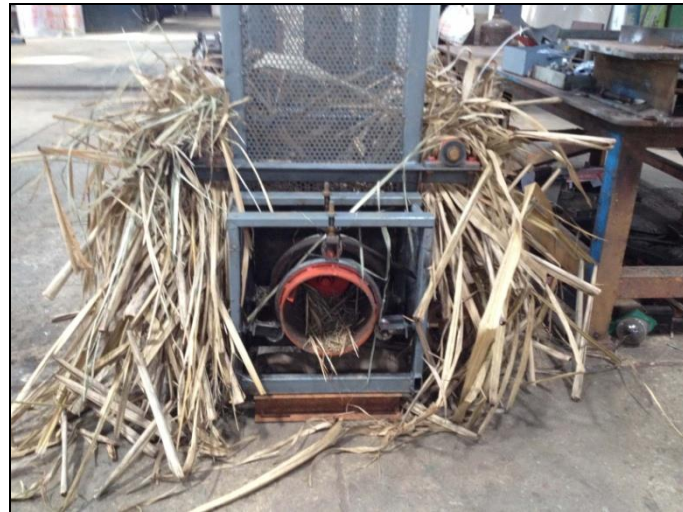
รูปที่ 14 ใบอ้อยติดขัดกับลูกปัด
