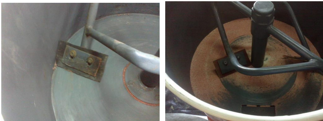
รูปที่ 10 การปรับปรุงเครื่องผสมปูนให้เป็นเครื่องผสมปุ๋ยโดยการใส่แผ่นยางที่ใบกวน
