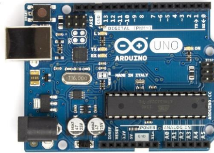
รูปที่ 17 บอร์ดวงจรไมโครคอนโทรลเลอร์ Arduino Uno R3
