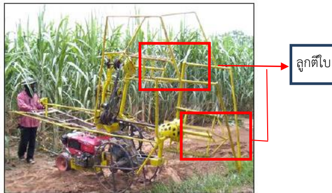
รูปที่ 1 เครื่องสางใบอ้อยติดตั้งกับรถไถเดินตาม
