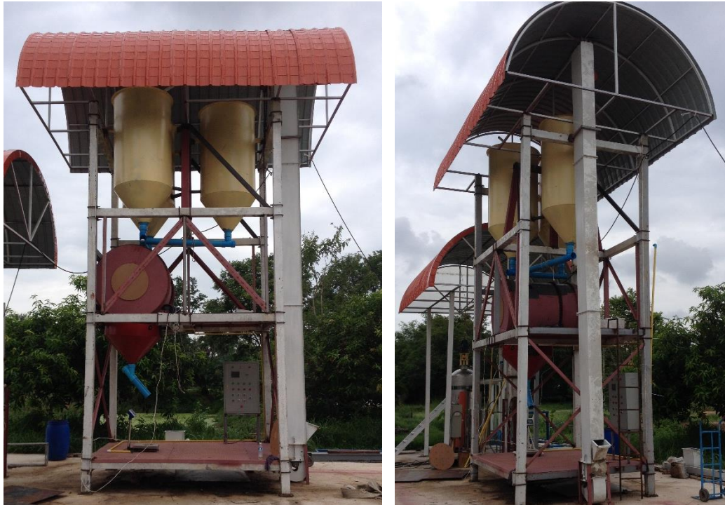
รูปที่ 5 เครื่องผสมปุ๋ยตามค่าวิเคราะห์ดินต้นแบบ
