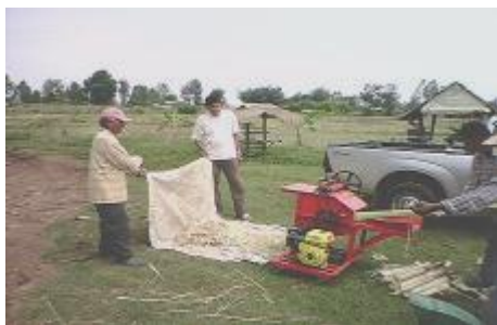
Figure 86 แสดงทดสอบหั่นต้นกล้วยต้องสับแบ่งต้นกล้วยก่อนป้อน
