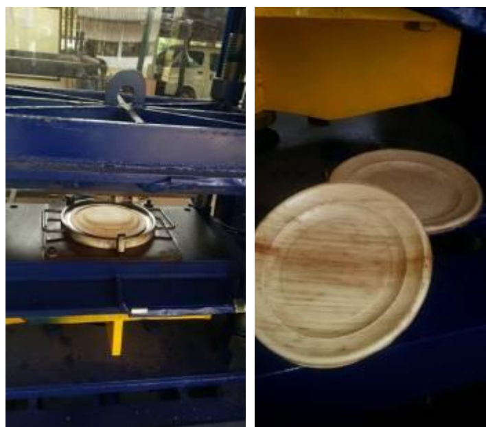
Figure 107 การอัดขึ้นรูปงาน โดยเครื่องต้นแบบขึ้นรูปบรรจุภัณฑ์ชีวภาพ และบรรจุภัณฑ์ที่ได้
