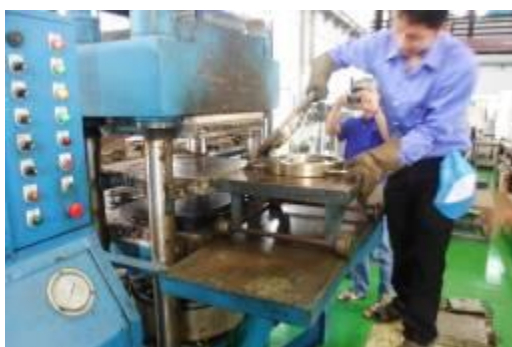
Figure 102 การอัดทดสอบ โดยใช้เครื่องอัดขึ้นรูปยางแผ่น ของสถาบันวิจัยยาง กรมวิชาการเกษตร
