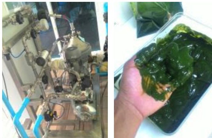
Figure 37 (ซ้าย) เครื่องแยกกากเซลล์แบบอัตโนมัติ (High performance self-cleaning Separator) (ขวา) ชีวมวลของไซยาโนแบคทีเรียที่เพาะเลี้ยงในระบบขยายขนาด
