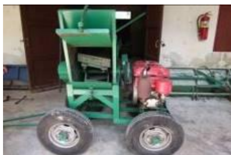
Figure 79 แสดงเครื่องหั่นทางปาล์มน้ำมันแบบของกรมวิชาการเกษตร
