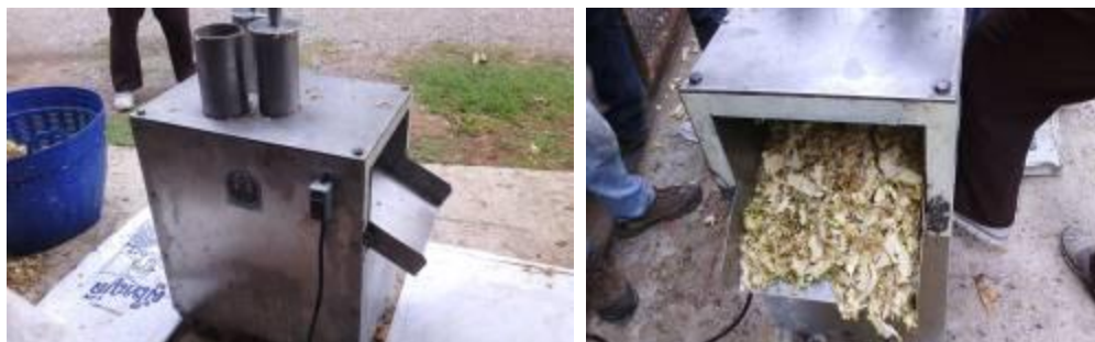
Figure 99 แสดงเครื่องหันเปลือกทุเรียนหลังการปรับปรุง
