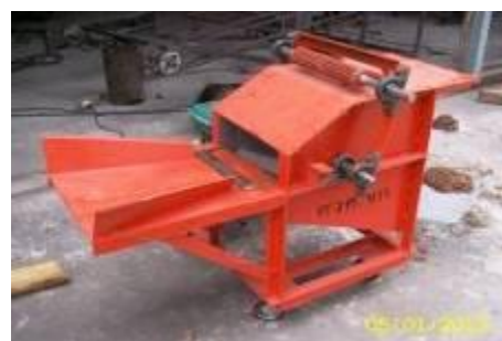
Figure 80 แสดงเครื่องหั่นย่อยต้นถั่วลิสงแบบของกรมวิชาการเกษตร
