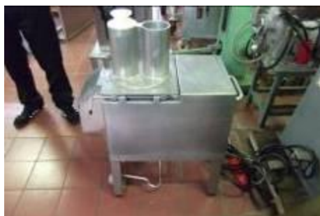
Figure 75 แสดงเครื่องฟานเนื้อผลไม้แบบของบริษัทเอกชน
