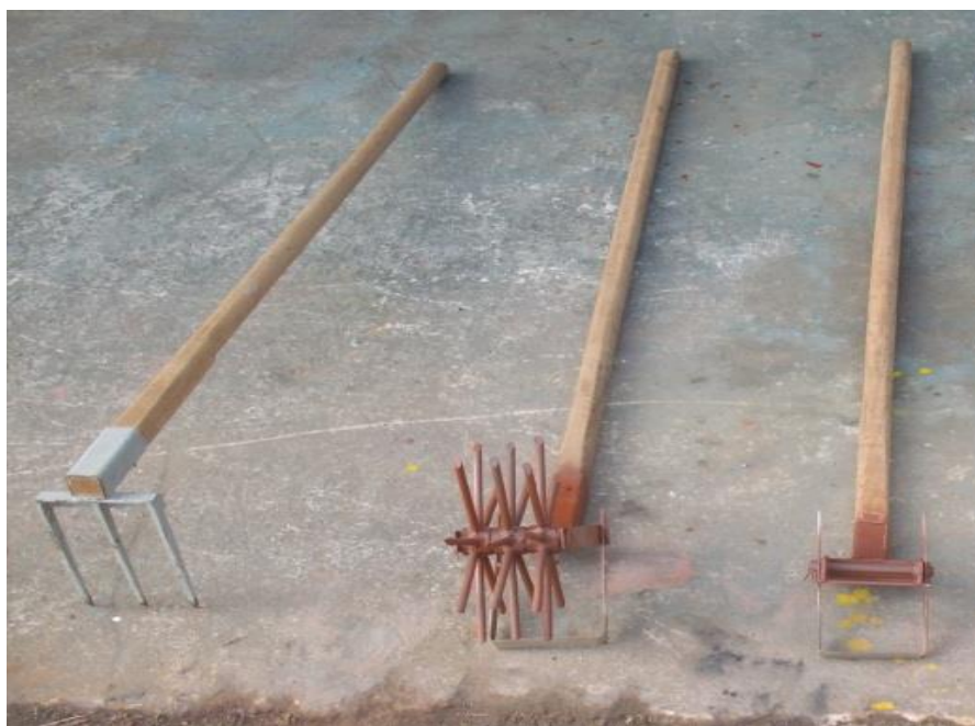
ภาพที่ 1 เครื่องมือพรวนดิน แบบจอบซี่ แบบใบมีดแฉ่ง แบบใบมีดแฉ่งติดกับล้อหนาม 8 แฉก (จากชวามาซ้าย)
